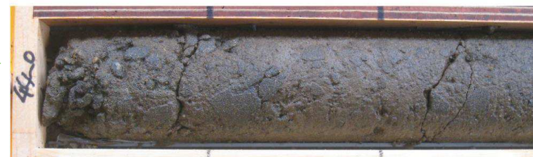
上盤側の凝灰質砂岩が角礫状(シルト質の基質を伴う)
