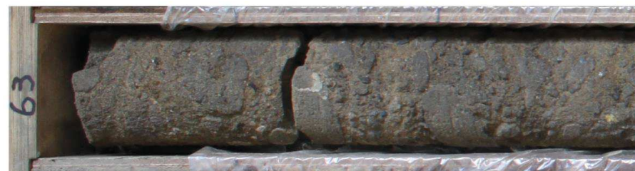
上盤側の凝灰質砂岩が角礫状
