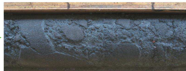
上盤側の凝灰質砂岩が角礫状(砂質の基質を伴う)
