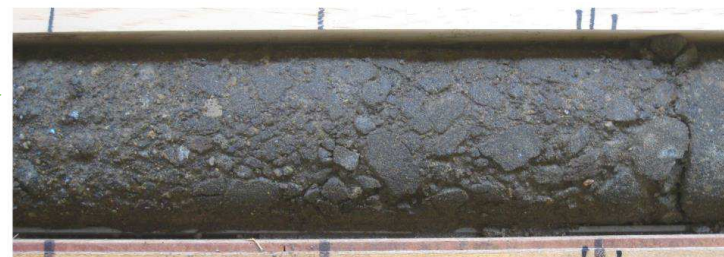
上盤側の凝灰質砂岩が角礫状(シルト質の基質を伴う)
