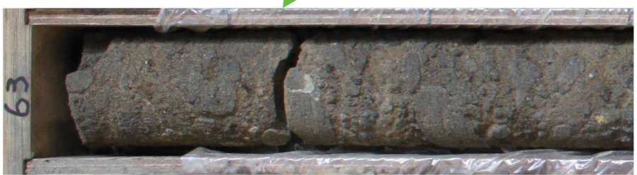
2019年撮影 上盤側の凝灰質砂岩が角礫状
