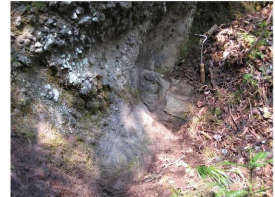
露頭④: 泊層凝灰角礫岩 西傾斜 66°
