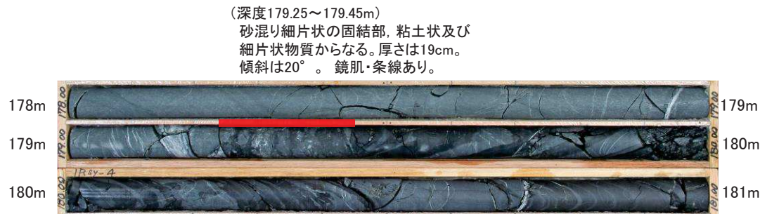
1Rsy-4孔(斜め60° ボーリング)コア写真
