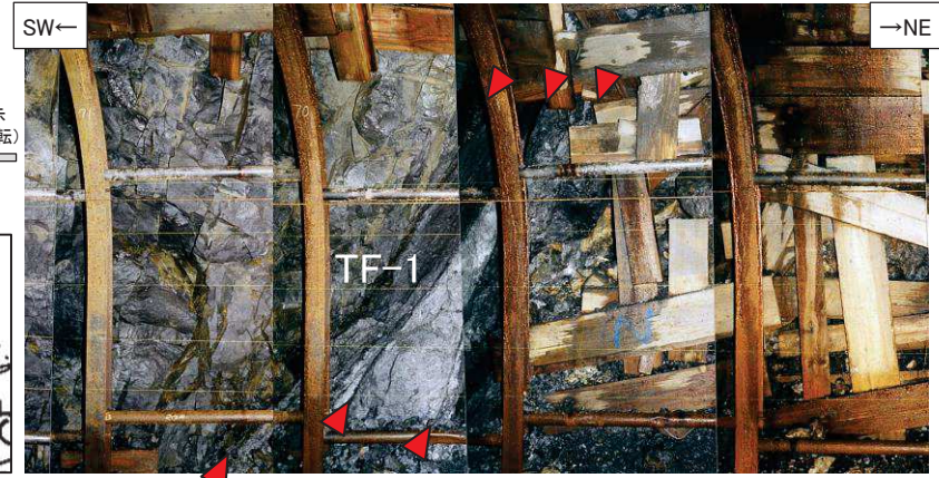
3号炉試掘坑2坑北西壁で確認したTF-1断層(左:スケッチ, 右:写真)
