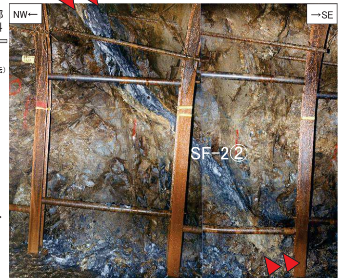
2号炉試掘坑A坑北東壁で確認したSF-2②断層(左:スケッチ, 右:写真)
