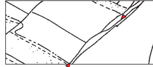
2号炉試掘坑B坑北西壁で確認したTF-2断層(左上:スケッチ, 右:写真)
