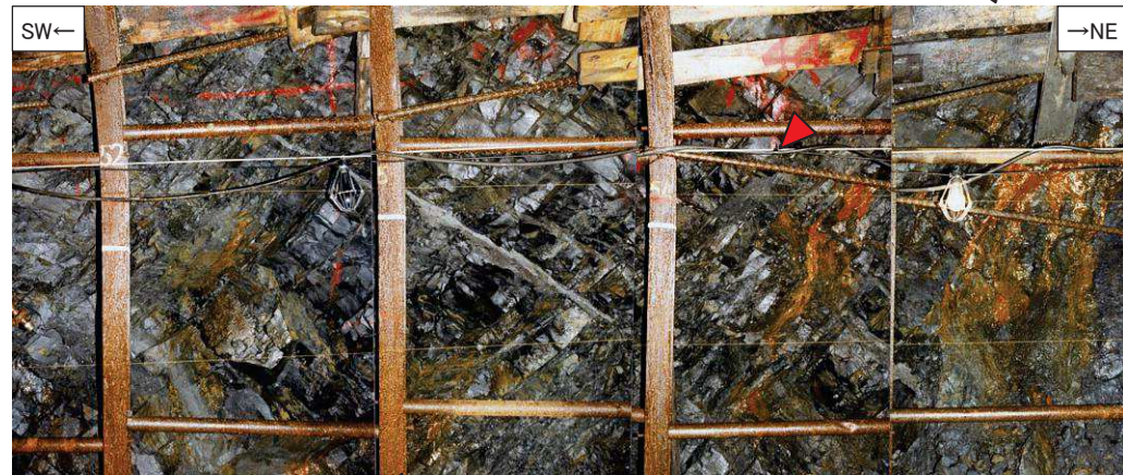
2号炉試掘坑B坑北西壁で確認したTF-3断層(下:写真, 右上:スケッチ)
