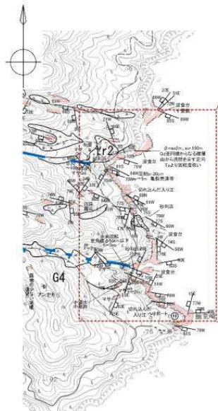
リニアメント東端の入り江にはリニアメントと同方向のE-W系の節理(青破線)が発達し卓越している。
