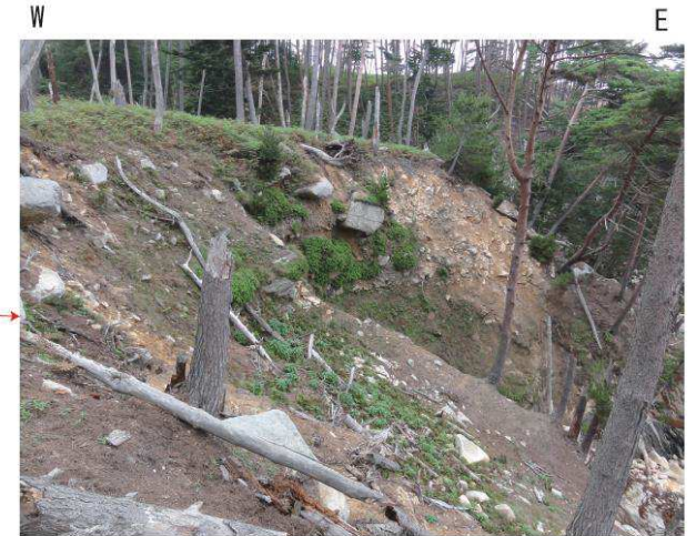
リニアメント東端近傍のM 1 面とその堆積物 巨礫を伴う角礫主体の礫層で、基底付近に垂角~垂円礫を混じえ、ほぼ水平の弱い堆積構造が認められる。
