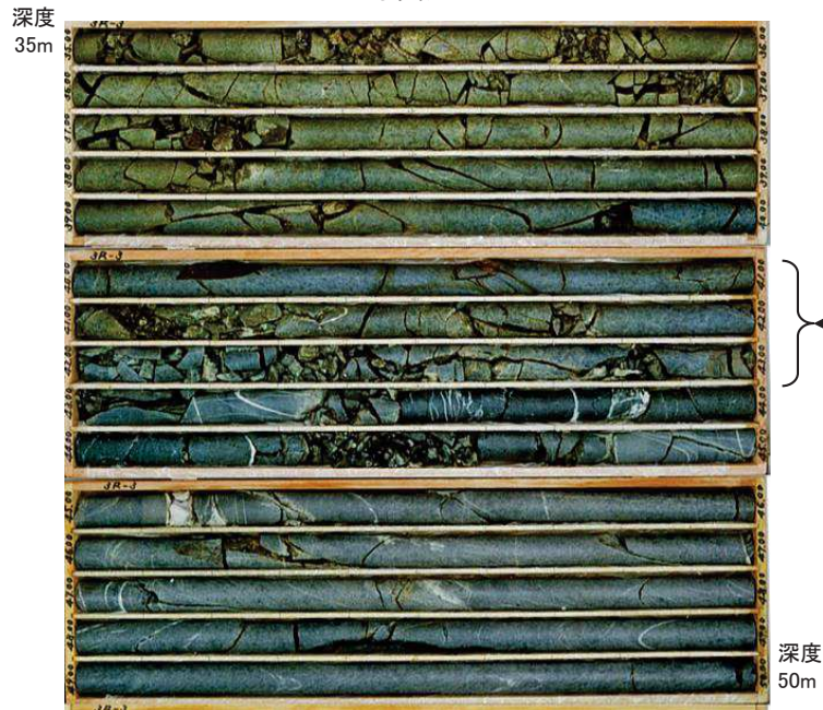
3R-3孔(ボーリングコア写真)
