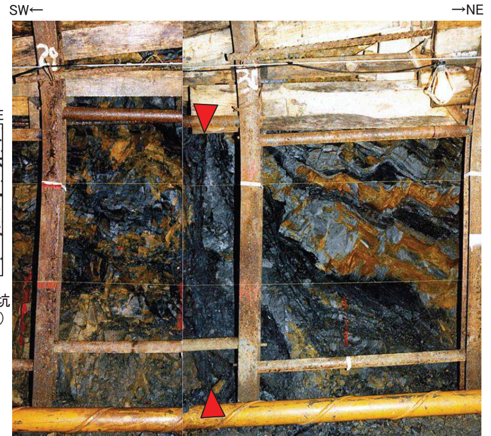
TF-2断層 2号炉試掘坑B坑北西壁写真
