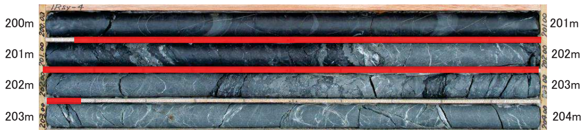
1Rsy-4孔(斜め60° ボーリング)コア写真
