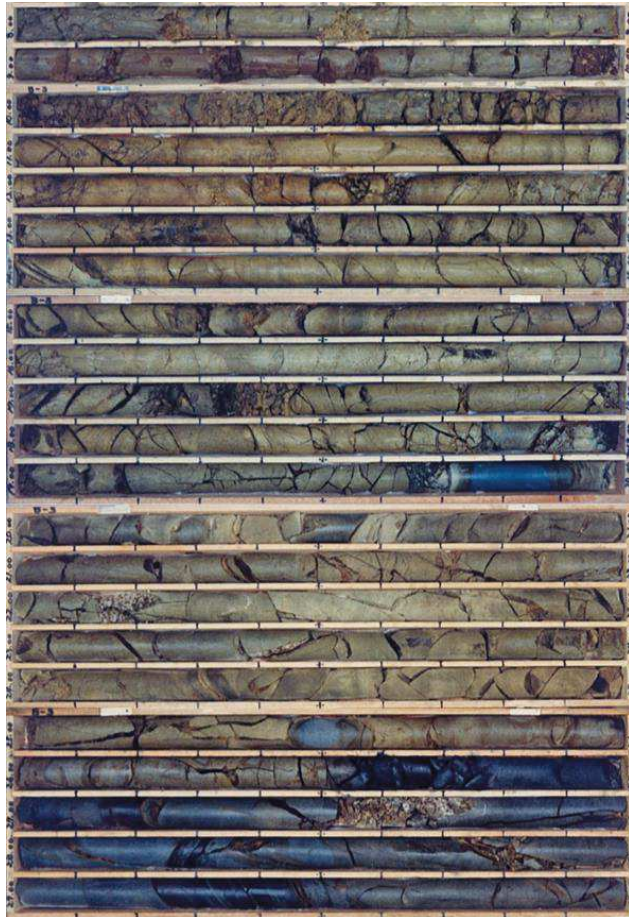
X655Y685(B-3) (ボーリングコア写真) 深度:8~30m
