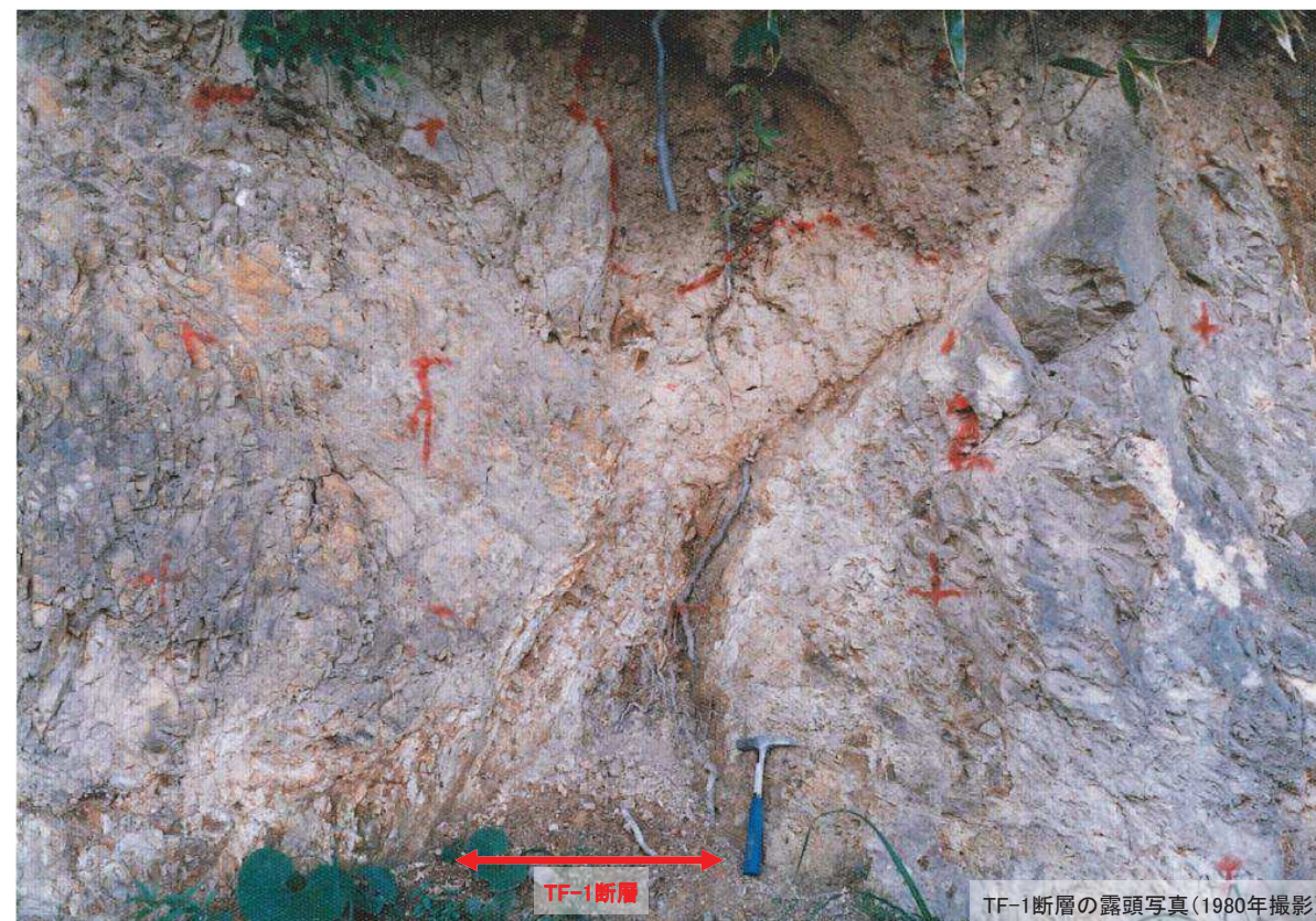
3号炉試験掘坑2坑北西壁で確認したTF-1断層(左:スケッチ, 右:写真)
