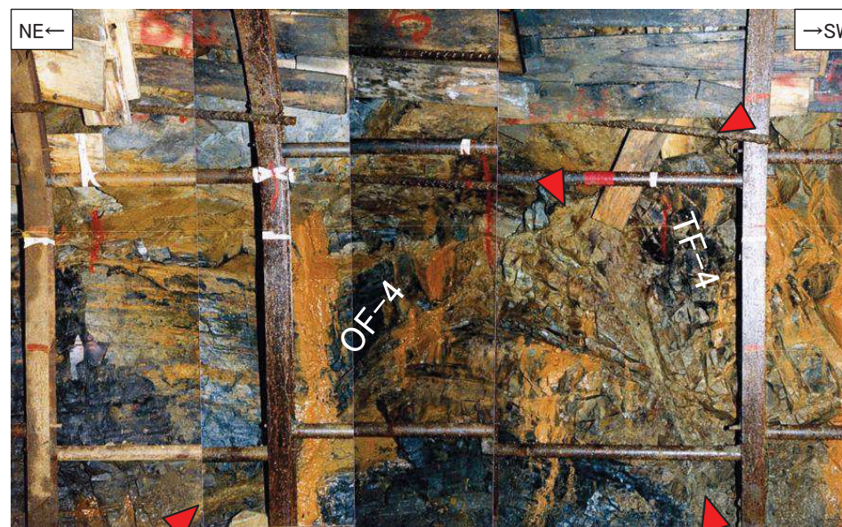
2号炉試掘坑B坑南東壁で確認したOF-4断層及びTF-4断層(下:写真, 右上:スケッチ)
