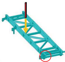
可動支承(西側)
