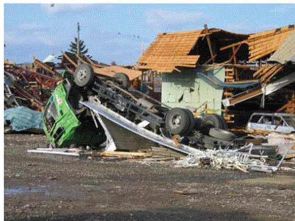
第6.3-4図 竜巻による被災後の4tトラックの様子 (26)(30)
