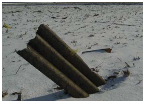
周囲の田に散乱した屋根ふき材
