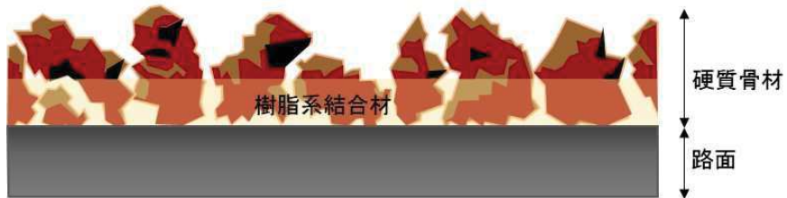
第3図 すべり止め舗装の構造
