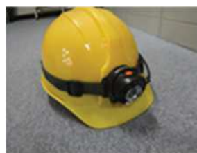
可搬型照明（SA） 可搬型照明（ヘッドライト）
