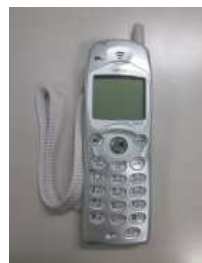
電力保安通信用電話設備 （PHS端末）
