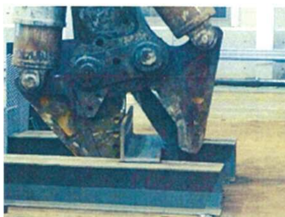
第18図 給排水処理建屋構造材切断模擬試験の様子
