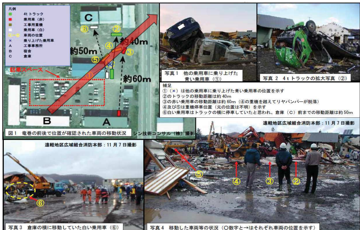
第6.3-1図 佐呂間竜巻（2006.11.7）による被災状況（工事事務所敷地内の車両被災） (25) 文献(24)で示されている竜巻被害の方向を で加筆
