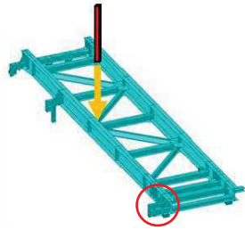
可動支承（西側）
