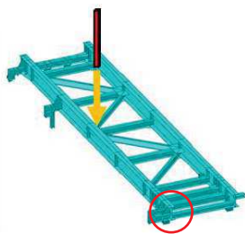
可動支承 (西側)
