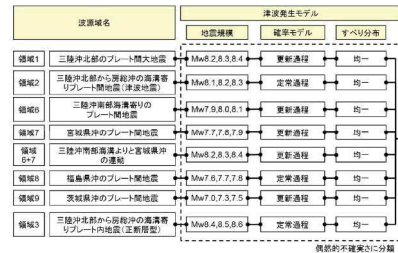
図8 旧津波想定モデルを適用する際の津波発生モデルのロジックツリー
