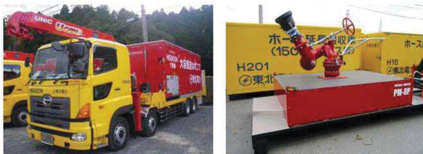
第3図 大容量送水ポンプ（タイプⅡ）及び放水砲
