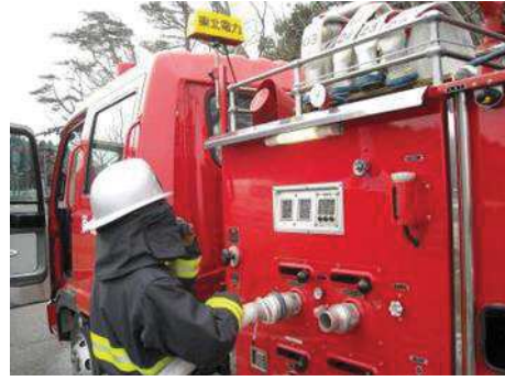
化学消防自動車へのホース接続
