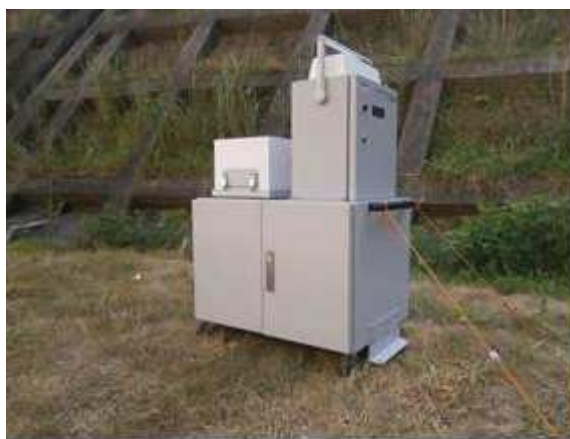
第2.3.3-1図 可搬型モニタリングポスト（設置イメージ）
