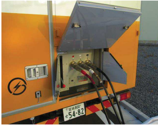
電源車ケーブル接続
