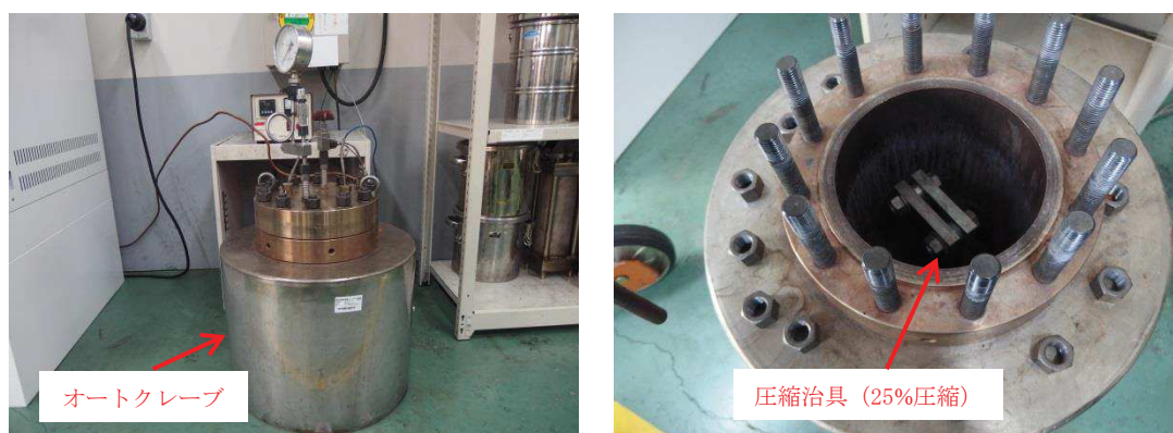
オートクレーブの外観
