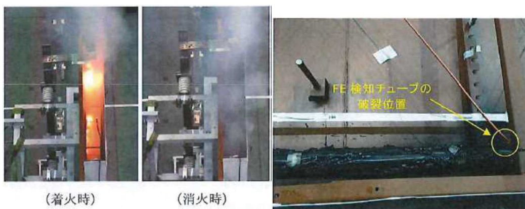
第 9 図：試験 V1 における着火・消火時の状態
