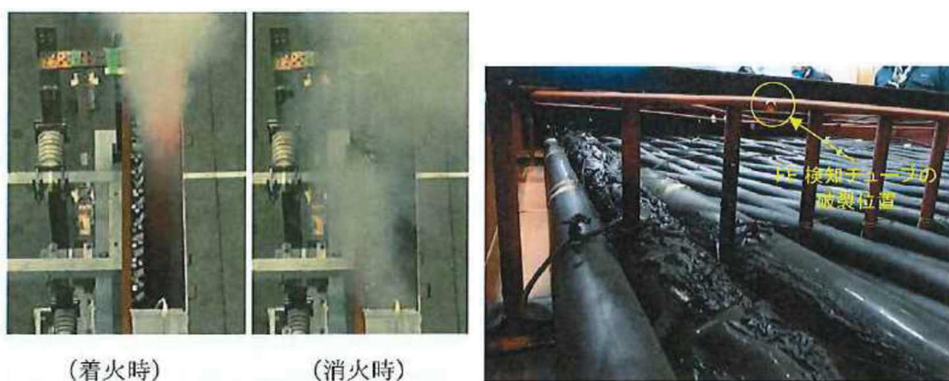
第 11 図：試験 V2 における着火・消火時の状態
