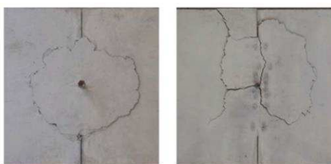
a) 試験体#1(ひび割れなし) b) 試験体#2(0.4mm)
