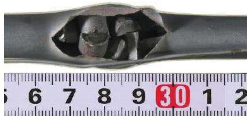
図1 ハルデン炉試験で確認されたペレットの破砕と被覆管破裂開口部への集積 [1]
