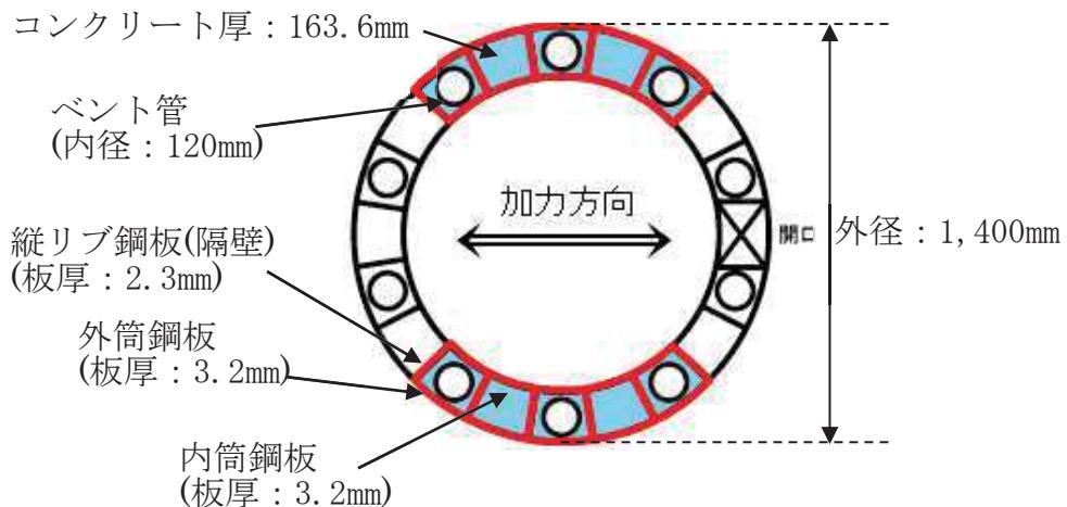
添付 2-11 図 せん断断面積の算出に考慮する各部材断面
