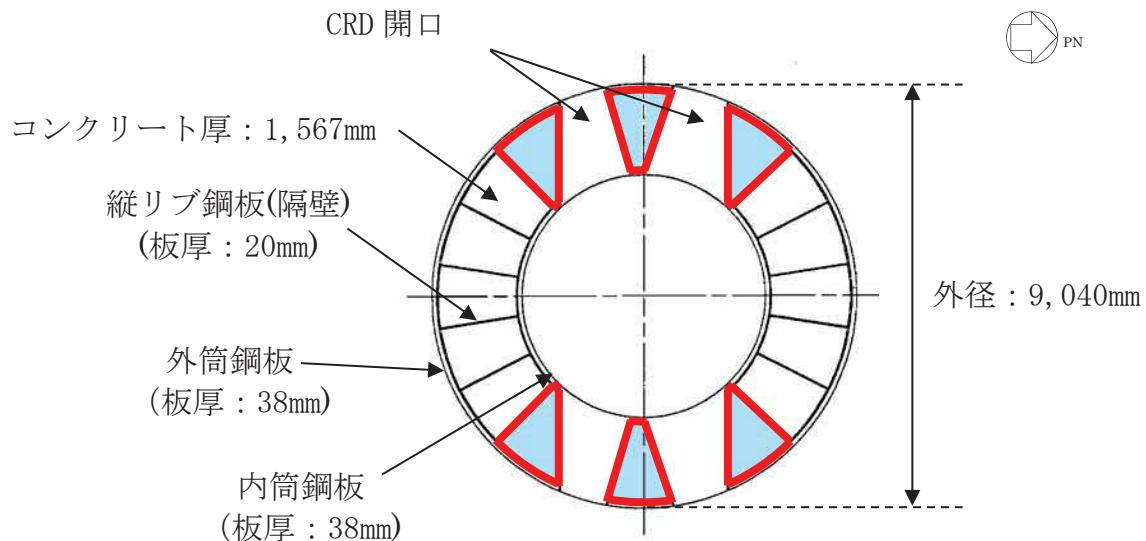
添付 2-22 図 せん断断面積の算出に考慮する各部材断面
