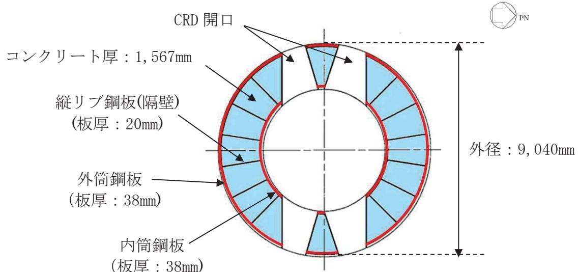
添付2-15図 ファイバーモデルに考慮する各部材断面
