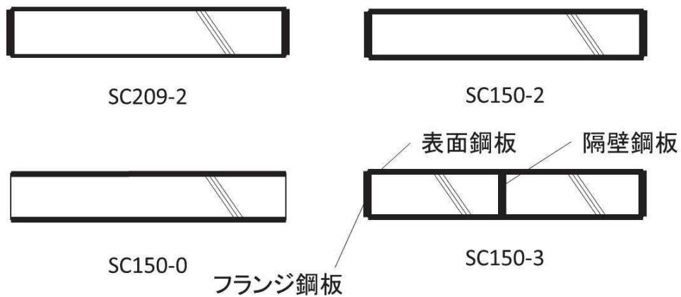
参考 2-5 図 試験 2 の各試験体縦断面
