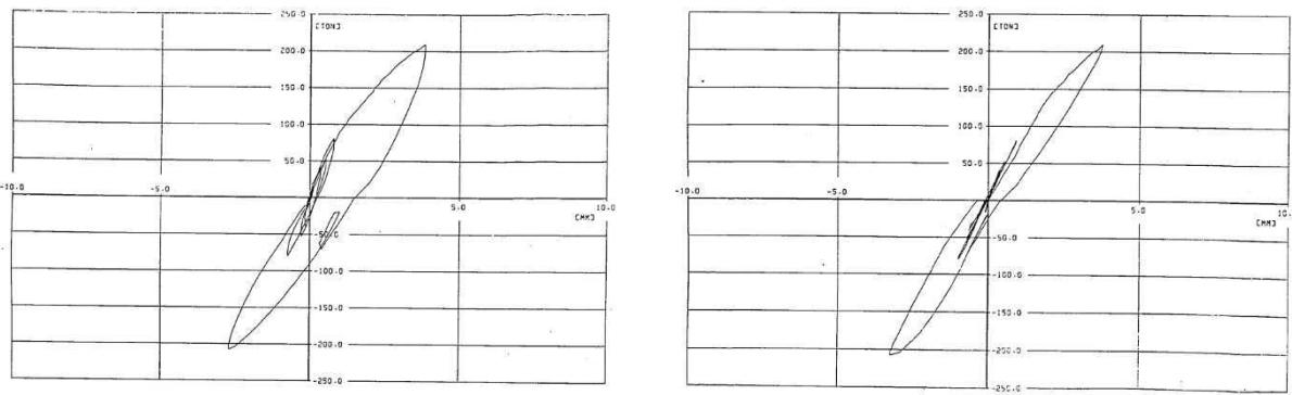
(a) 荷重-曲げ変形関係 (b) 荷重-せん断変形関係
