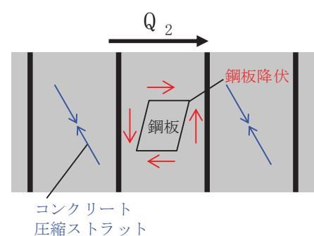
第 4.3-2 図 RC 構造と RPV ペデスターのせん断に対する抵抗機構
