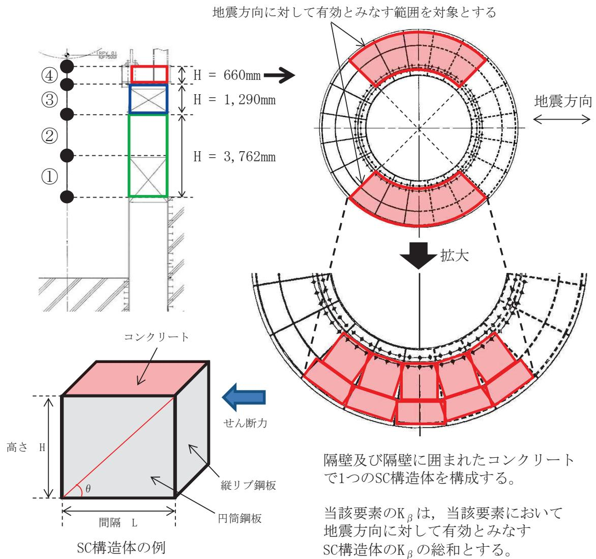
第 5.3-9 図 RPV ペデスタルの隔壁構造の概念図（要素④を例示）
