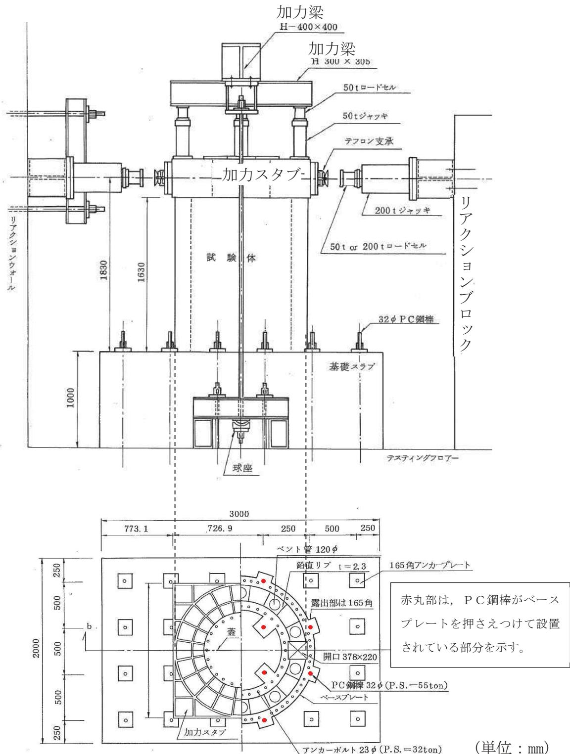
添付 3-2 図 RPV ペデスタルの試験体と加力装置の概要
