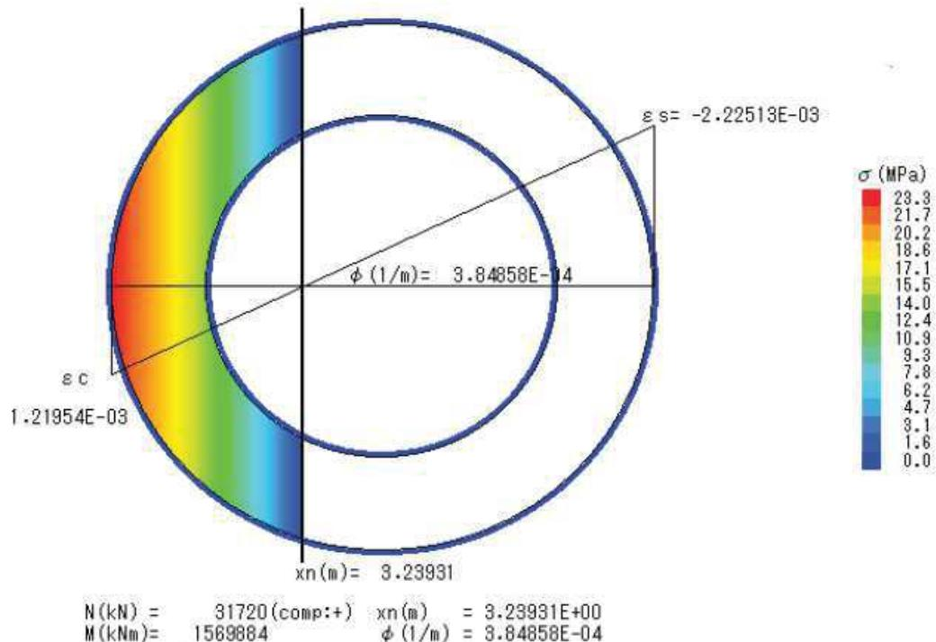
添付 2-18 図 ファイバーモデルによる解析結果 【NS 方向】
