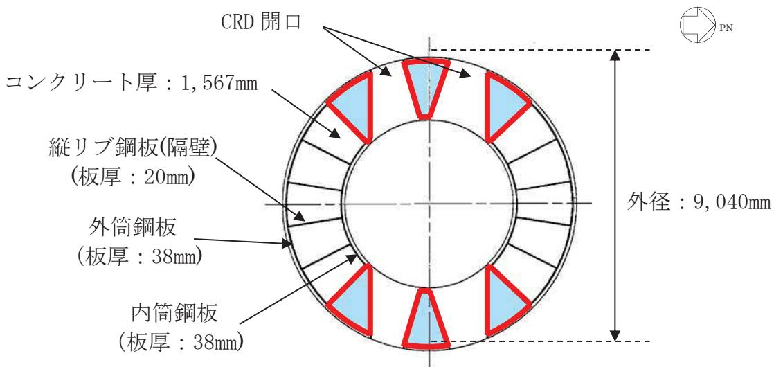
添付 2-26 図 せん断断面積の算出に考慮する各部材断面
