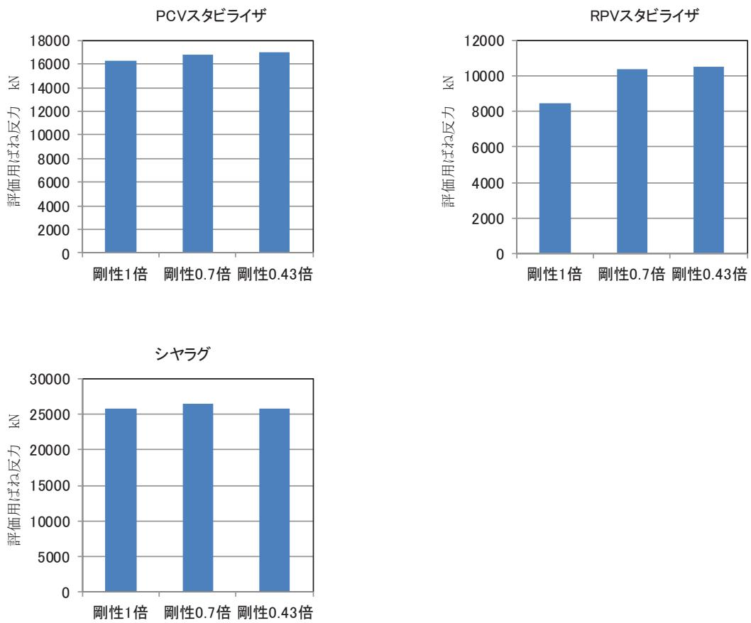
添付 5-3 図 基準地震動 Ss-2 に対する各部位の地震応答の比較 (2/2)
