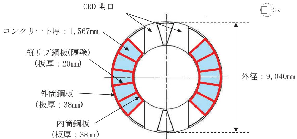
添付 2-23 図 せん断断面積の算出に考慮する各部材断面
