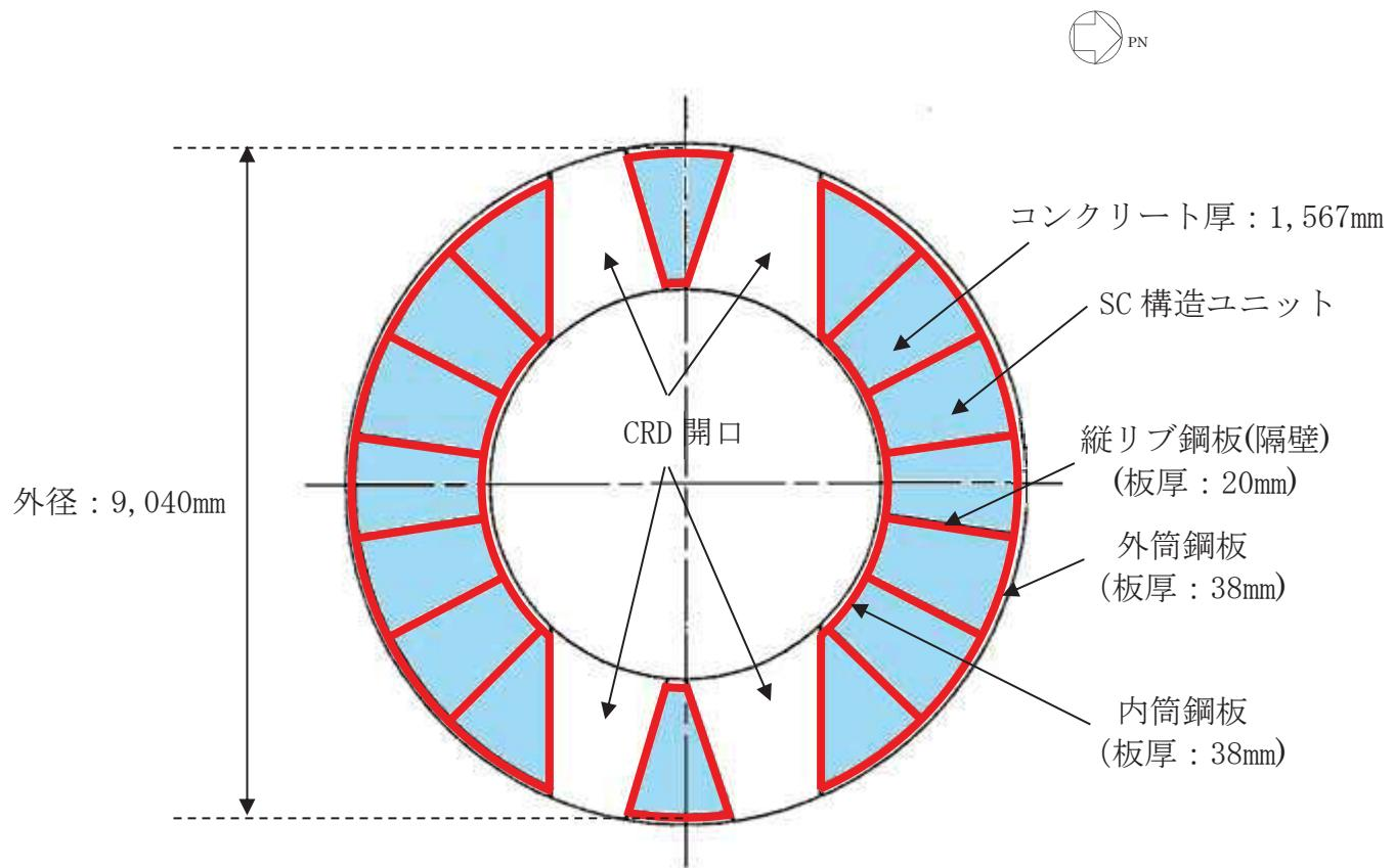
添付 2-24 図 SC 構造体ユニット (赤: 鋼板, 水色: コンクリート)
