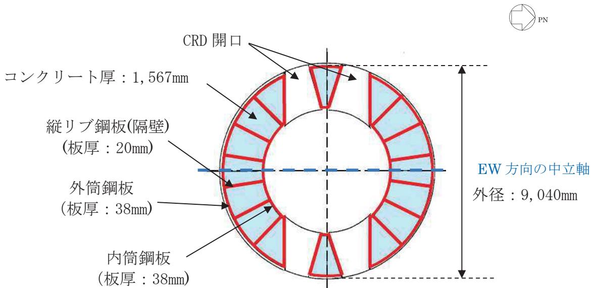
添付 2-14 図 断面二次モーメント及び断面積の算出に考慮する各部材断面
