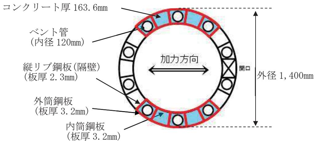
添付 2-7 図 セン断面積の算出に考慮する各部材断面
