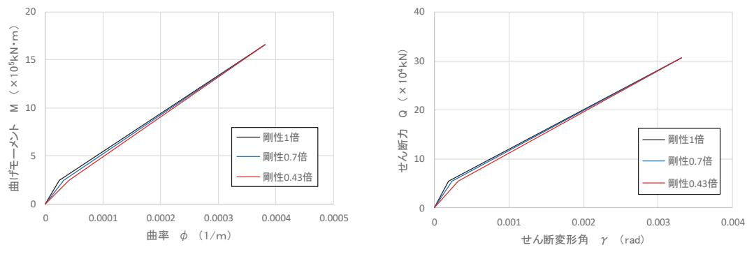
添付 5-1 図 評価に用いたスケルトンカーブ
