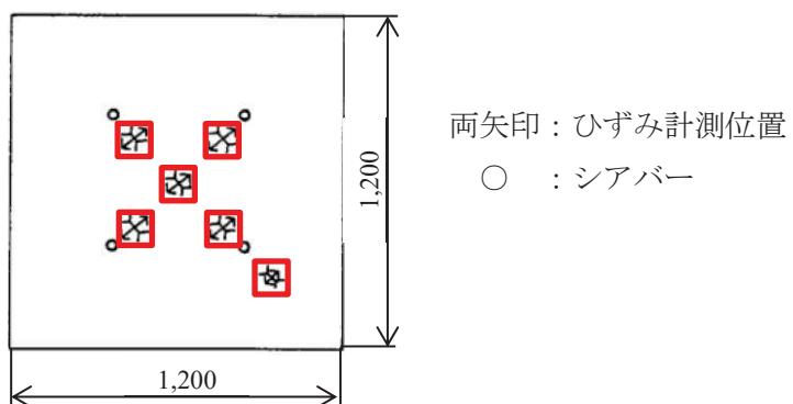
参考 2-16 図 鋼板のひずみ計測点 (SC150-2)
