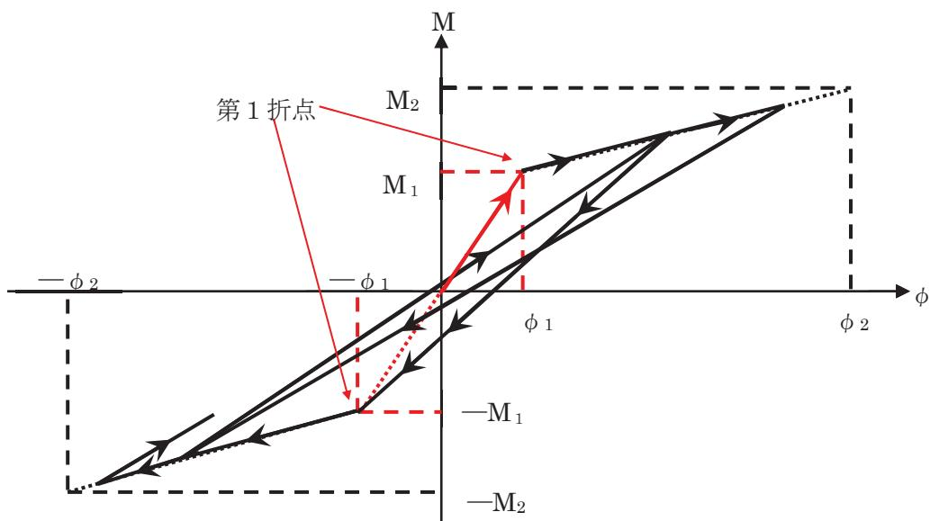
添付 1-1 図 最大点指向型の履歴特性の例（曲げモーメント）
