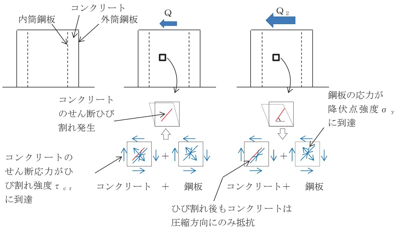
第 5.3-8 図 RPV ペデスタルのせん断変形の状態概念図
