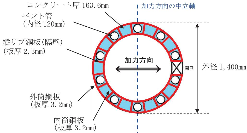
添付2-2図 断面二次モーメント及び断面積の算出に考慮する各部材断面
