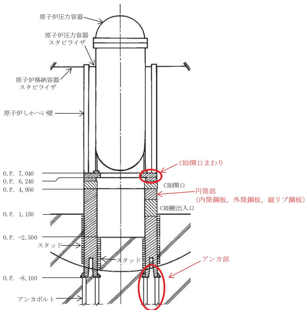
第 2.4-1 図 RPV ペデスタルの構造強度評価部位
