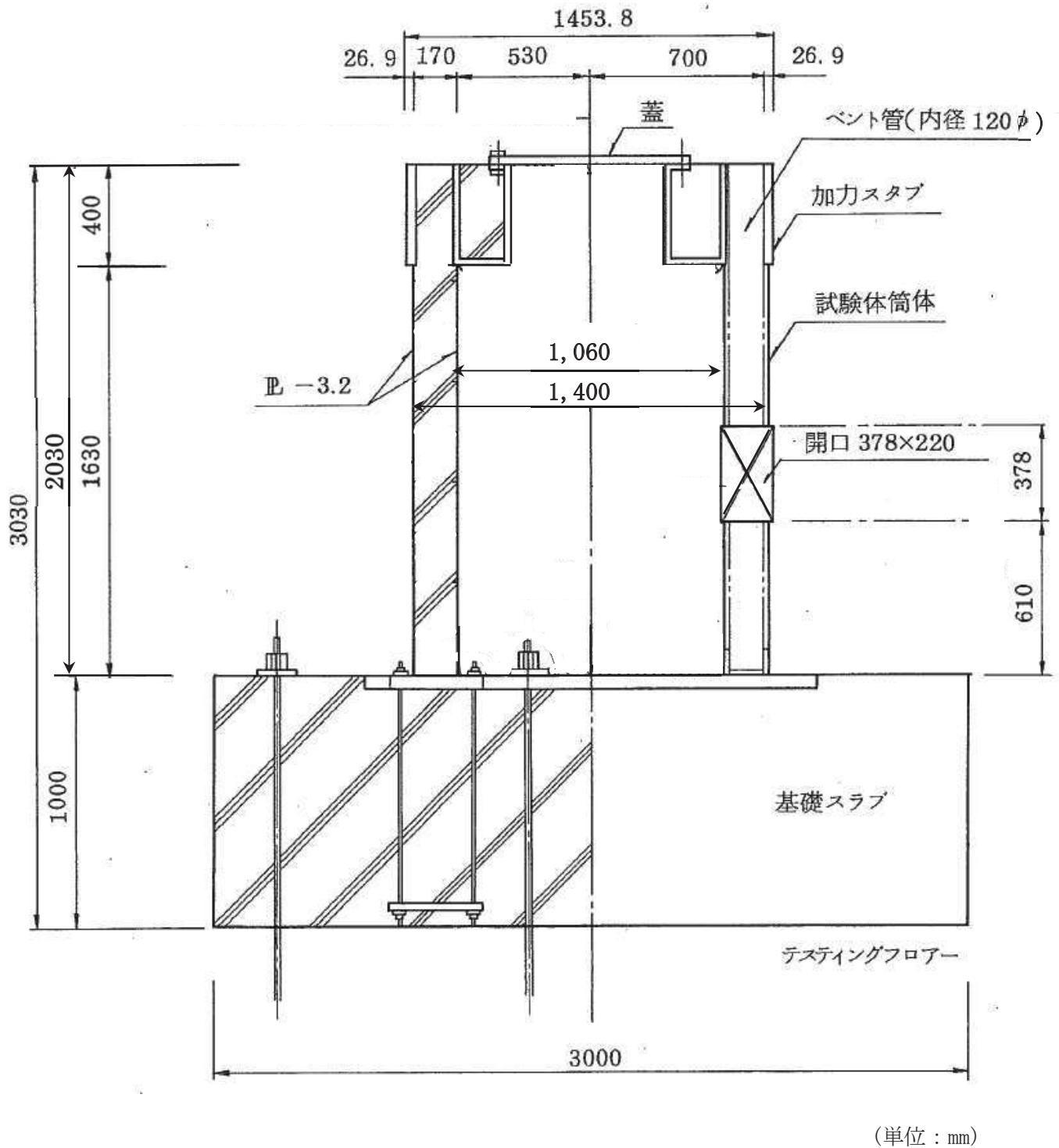
添付 4-2 図 試験体の断面図 (参考文献(1)より引用, 加筆)
