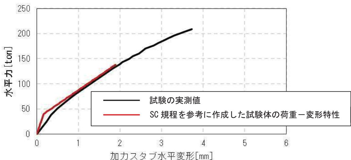
添付 3-7 図 荷重-変形関係の比較（せん断変形）
