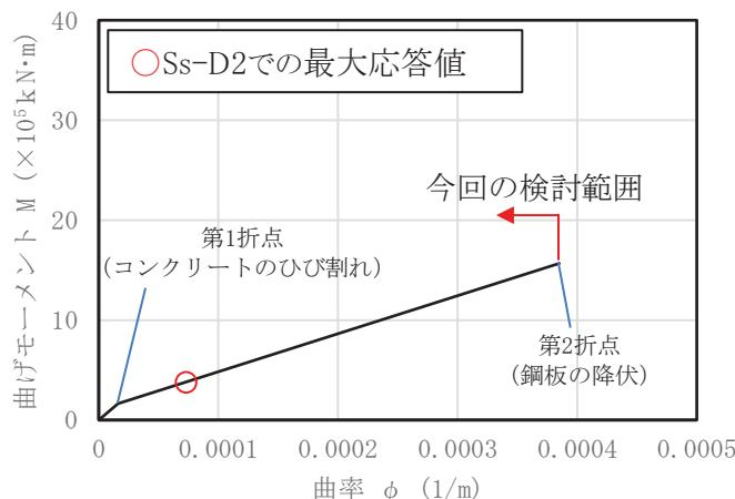
第 1-1 図 今回工認の基準地震動 Ss に対する RPV ペデスタルの地震応答の例
