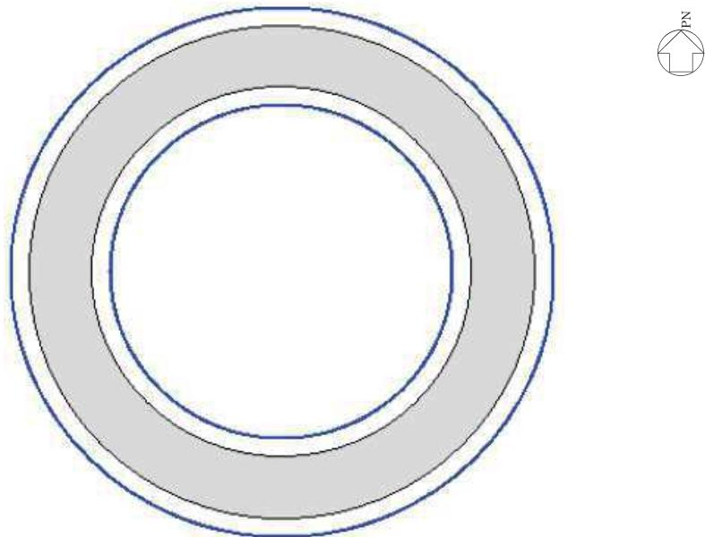
添付 2-17 図 ファイバーモデル構造図(黒線の間がコンクリート, 青線が鋼板)
