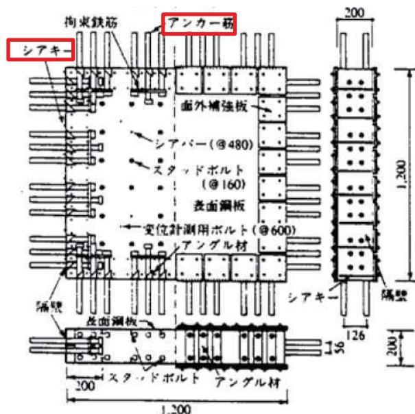
参考 2-17 図 試験体及び加力装置
