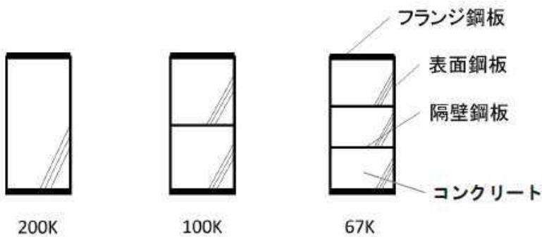
参考 2-1 図 試験 1 の試験体断面
