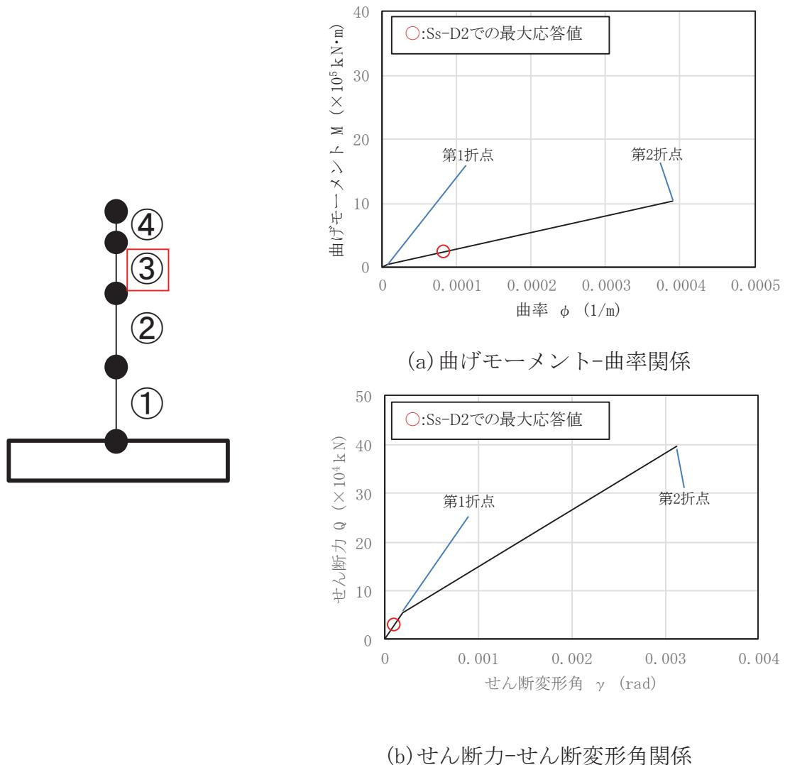
第 6-1 図 SC 規程を参考にした RPV ペデスタルのスケルトンカーブ (6/8)
