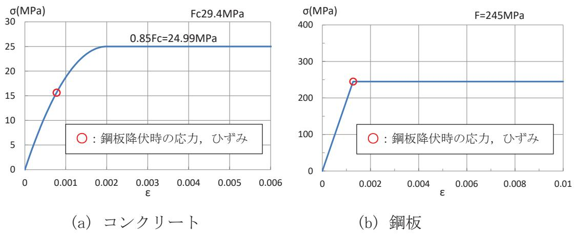
添付 2-6 図 コンクリート及び鋼板の応力ひずみ関係
