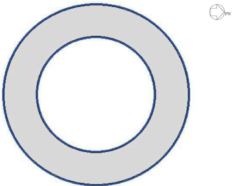
添付 2-16 図 ファイバーモデル構造図(黒線の間がコンクリート, 青線が鋼板)
