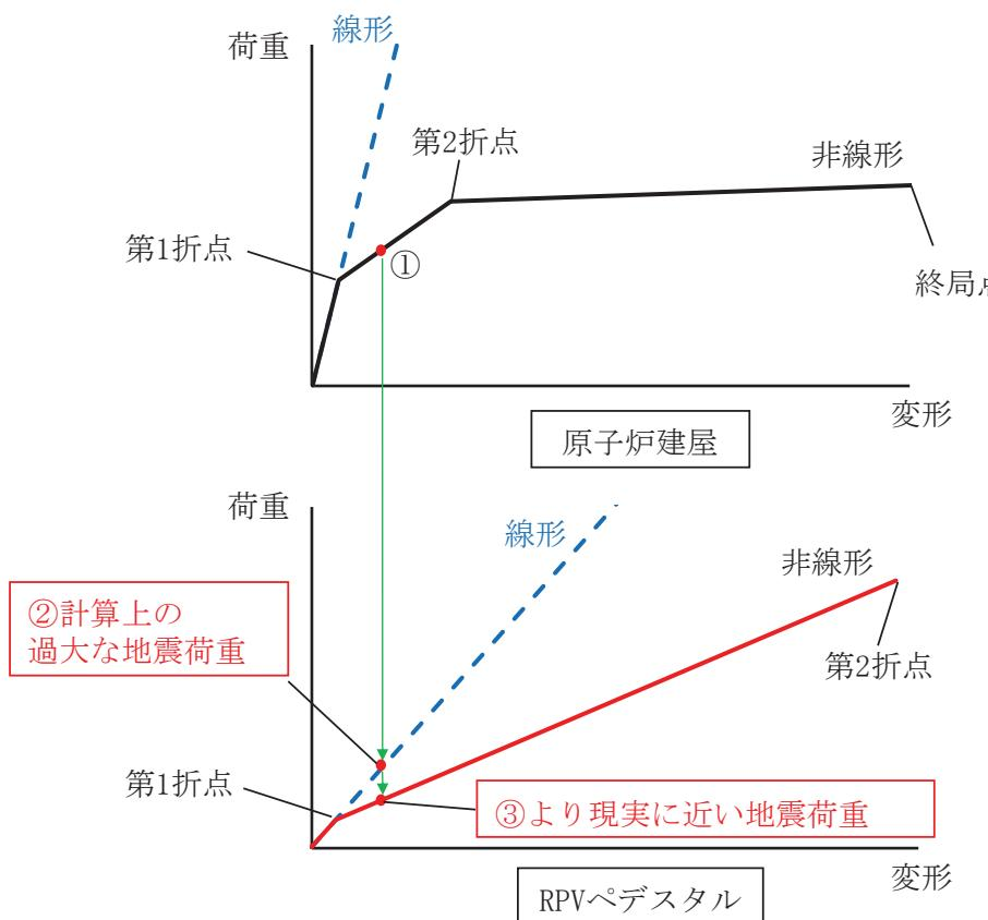
第3.1-1図 地震力の増大に伴うRPVペデスタルの応答増加の概念図
