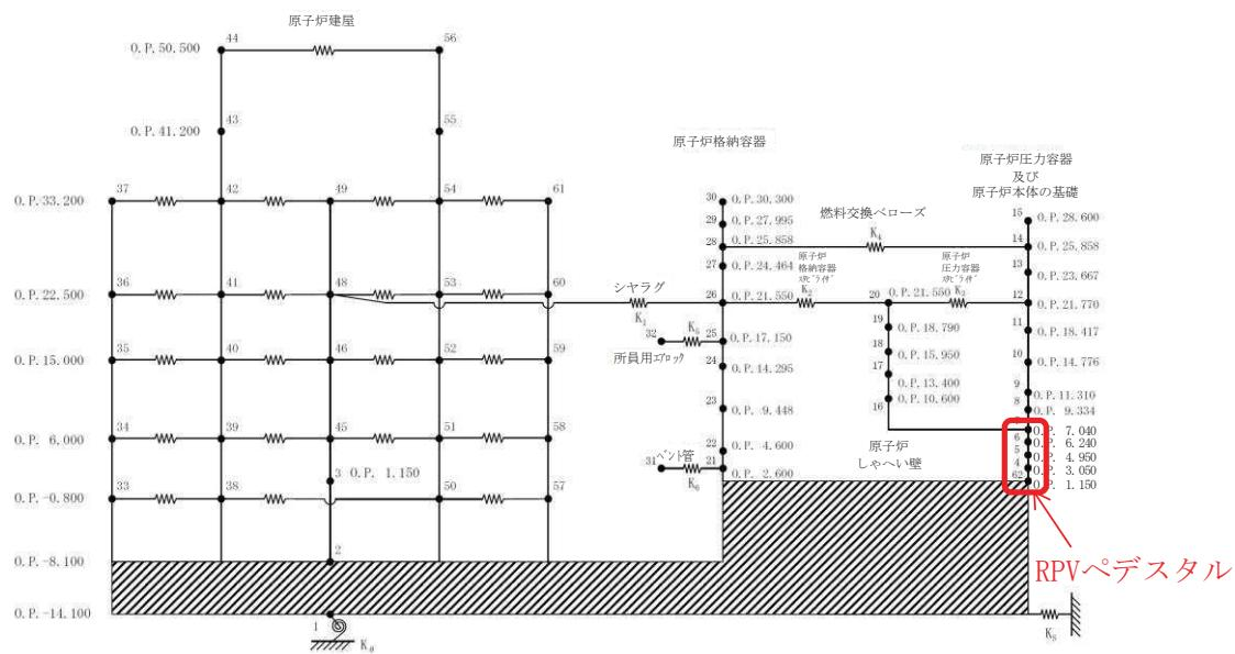
第 2.3-1 図 地震応答解析モデルの例
