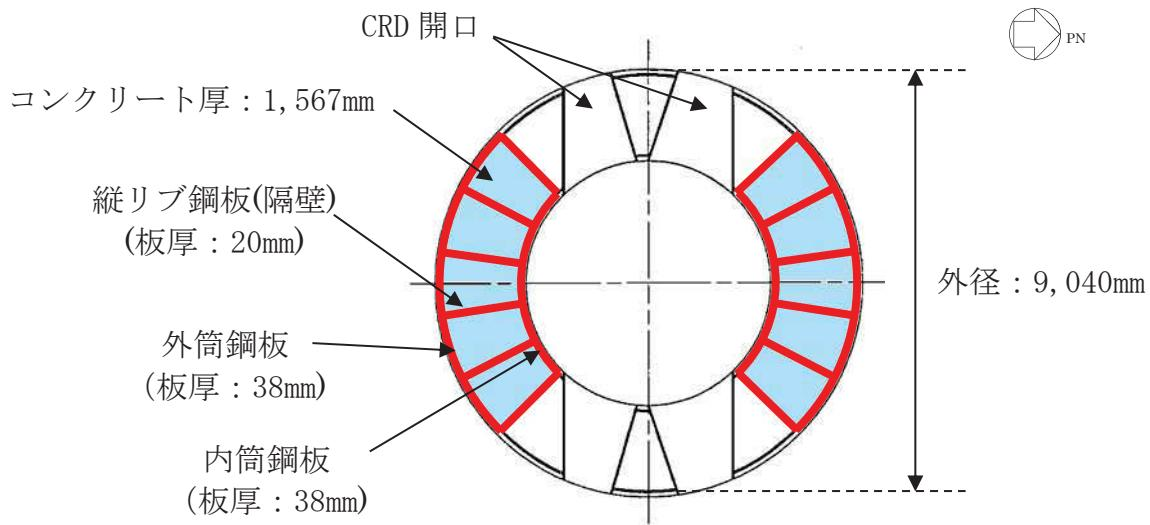
添付 2-27 図 せん断断面積の算出に考慮する各部材断面
