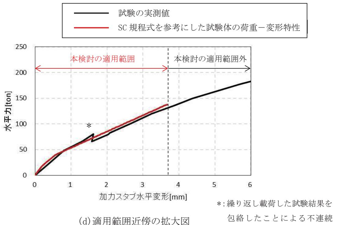
第 5.4-2 図 荷重-変形特性の比較 (2/2)
