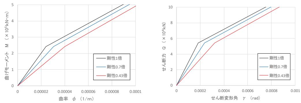
添付 5-2 図 評価に用いたスケルトンカーブ (第 1 折点付近の拡大図)
