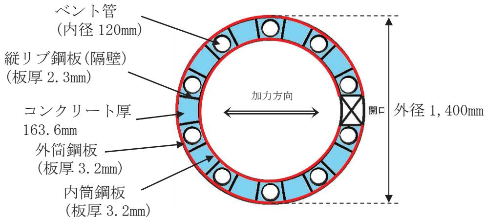
添付2-3図 ファイバーモデルに考慮する各部材断面
