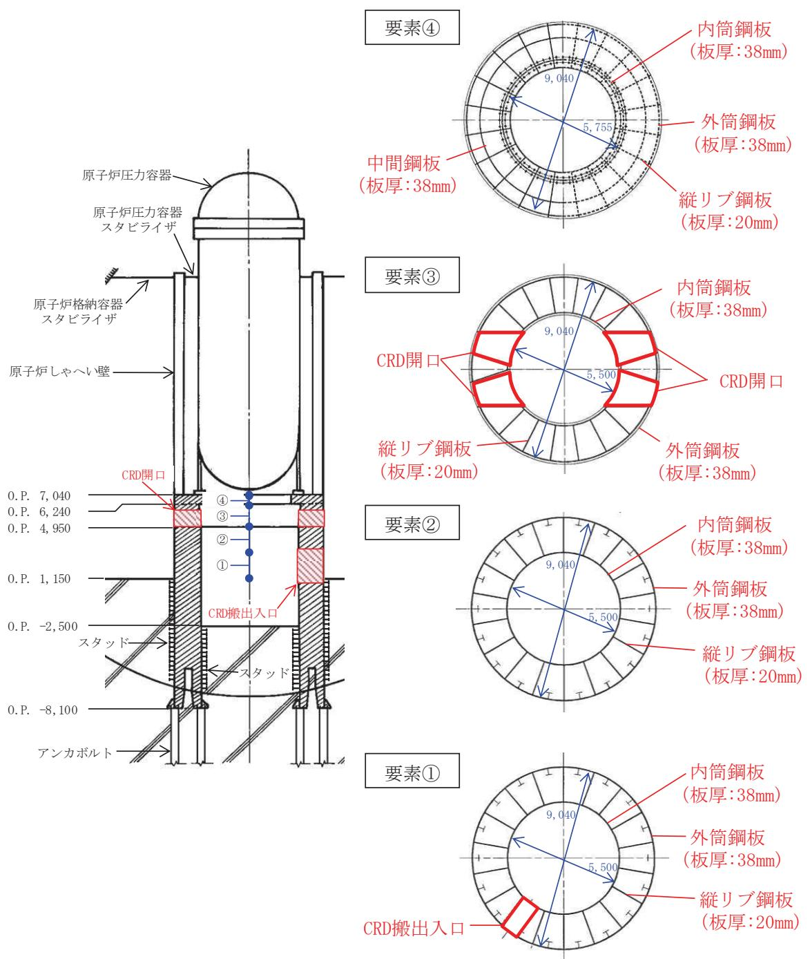
第 5.3-1 図 RPV ペデスタルと地震応答解析モデルの対応
