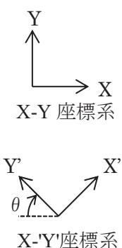
添付 10-3 図 ひび割れ後の応力状態の仮定
