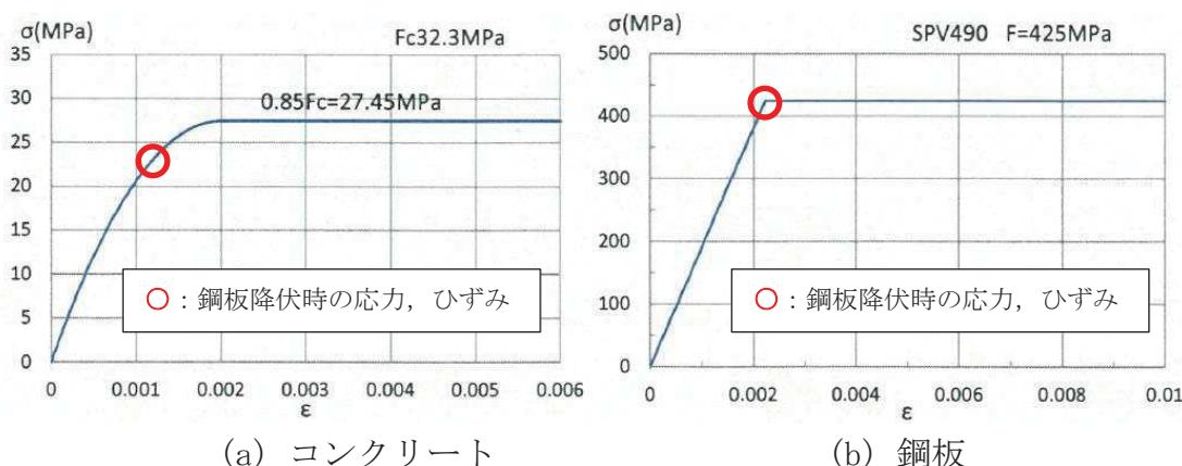
添付 2-19 図 コンクリート及び鋼板の応力ひずみ関係 【NS 方向】
