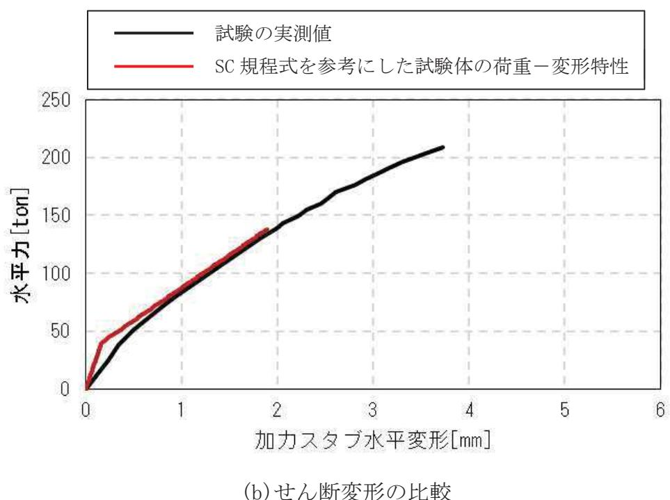
第 5.4-2 図 荷重-変形特性の比較 (1/2)
