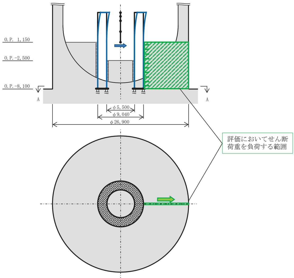
添付 11-2 図 RPV ペデスタル下部の周辺コンクリートへのせん断荷重伝達イメージ
