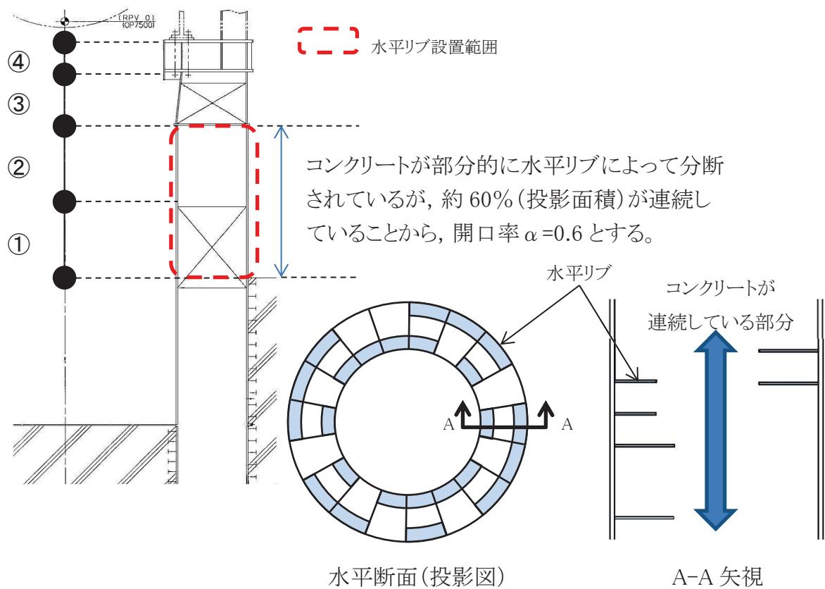
第 5.3-4 図 水平リブの配置概要図
