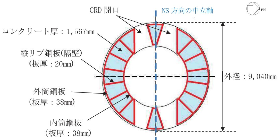
添付 2-13 図 断面二次モーメント及び断面積の算出に考慮する各部材断面
