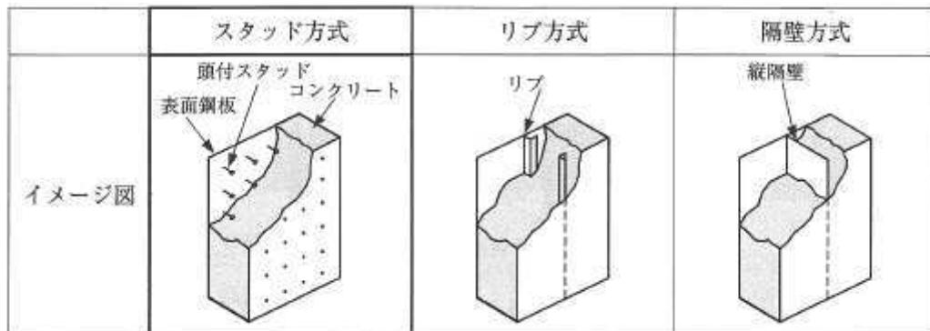
第 5.1-1 図 SC 構造の各種構造形式（例）((4) より引用)
