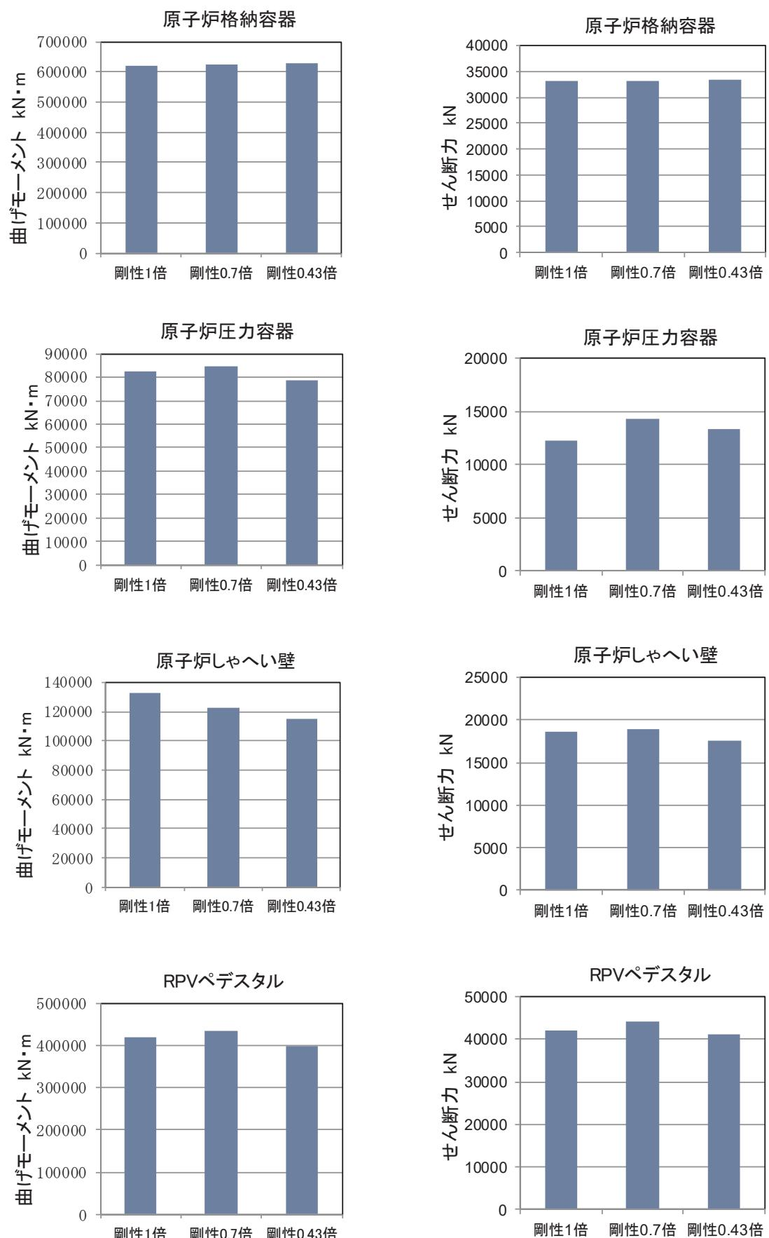
添付 5-3 図 基準地震動 Ss-2 に対する各部位の地震応答の比較 (1/2)
