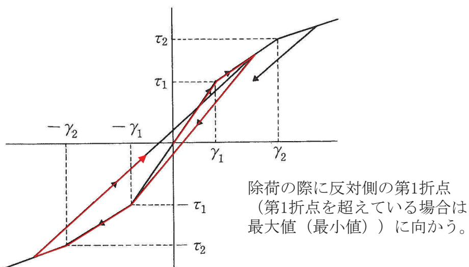
第 7.3-1 図 履歴特性のイメージ (最大点指向型)
