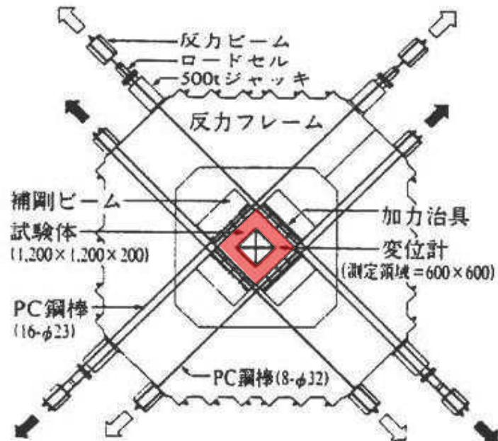
参考 2-6 図 試験 2 の加力装置概要
