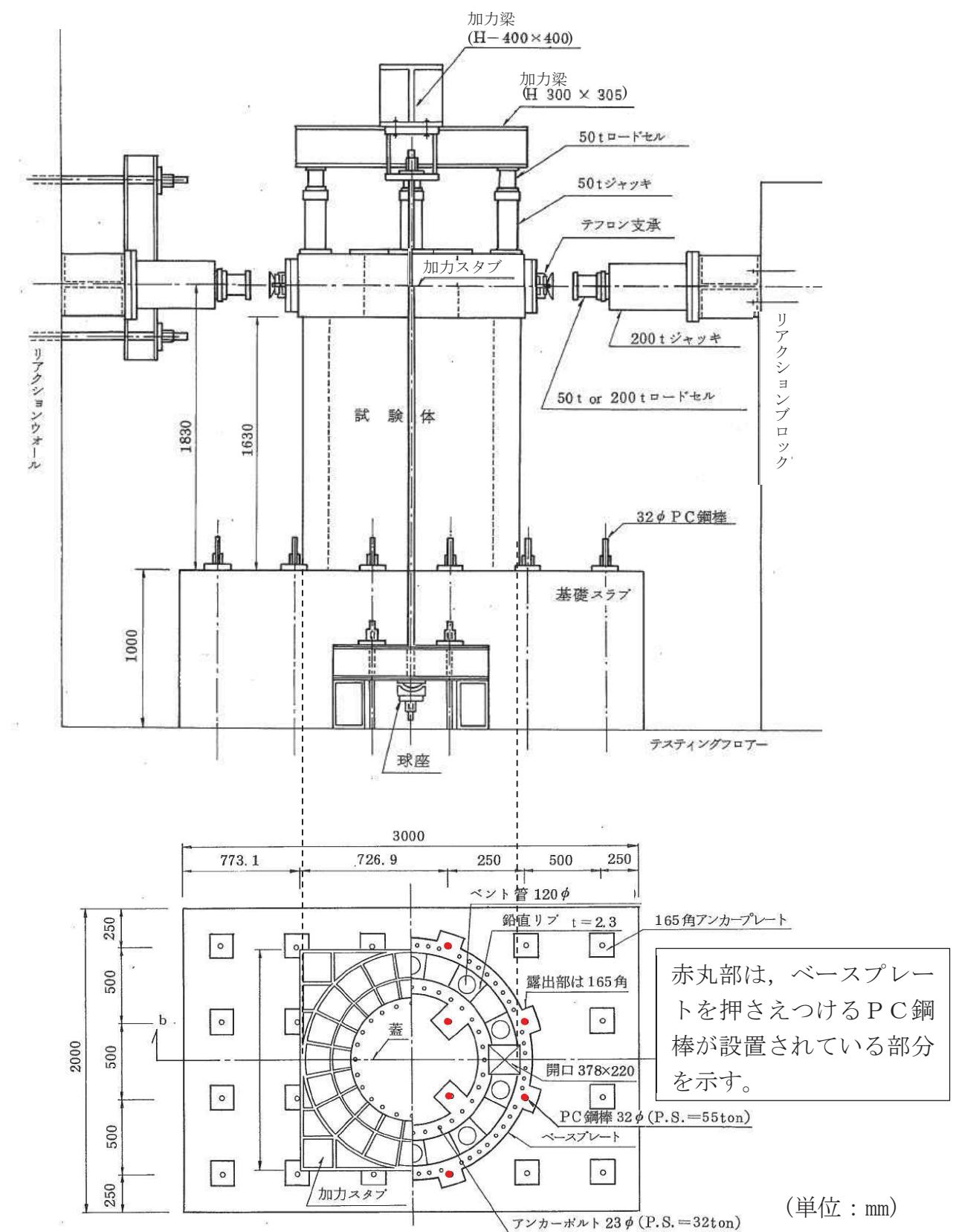
添付 4-1 図 RPV ペデスタルの試験体と加力装置の概要
