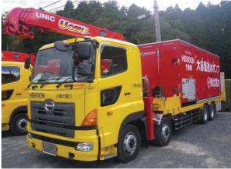
大容量送水ポンプ（タイプ I）
