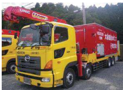
大容量送水ポンプ（タイプ I）の設置
