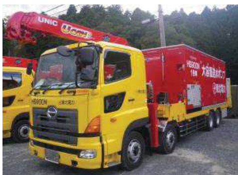
大容量送水ポンプ（タイプ I）
