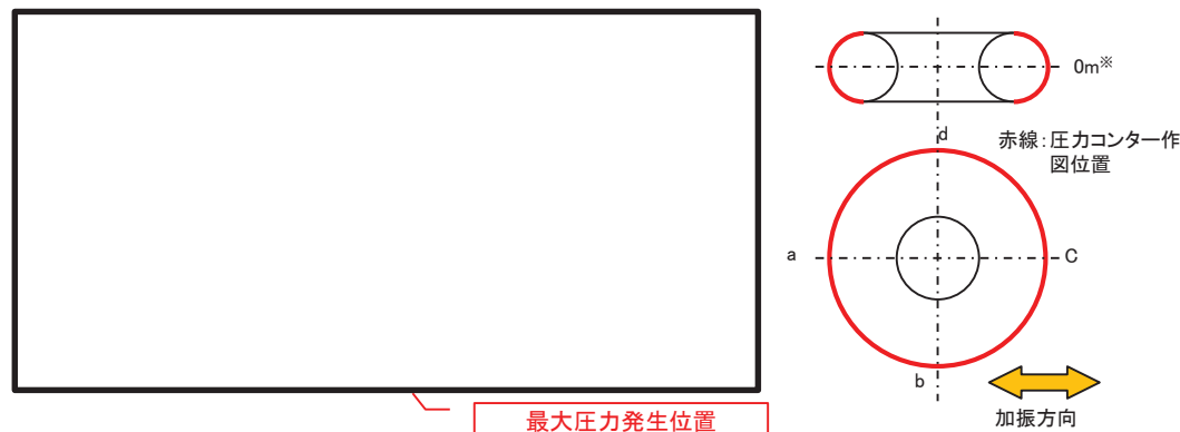
図2 サプレッションチェンバの圧力コンター図 (SA水位より高い水位, Ss-D1(水平方向))
