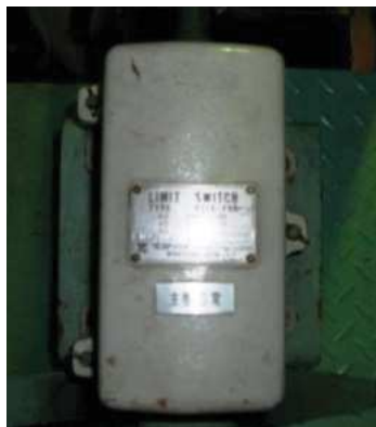
図 5.2.16 過巻防止用リミットスイッチ (主巻, 補巻上装置)
