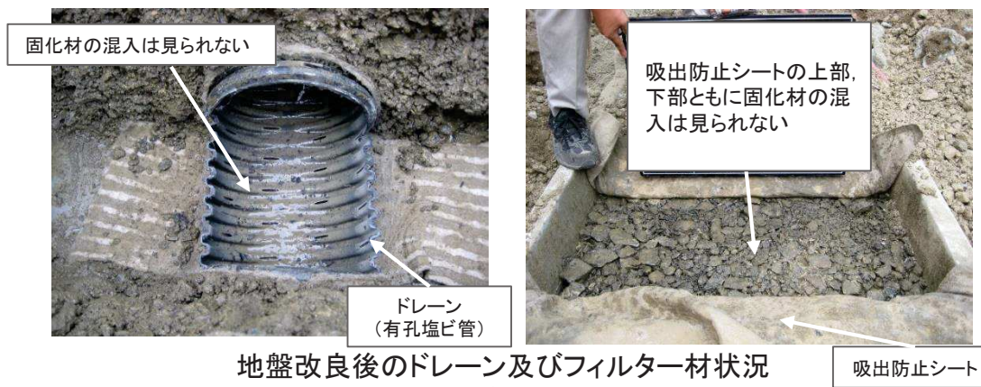
地盤改良後のドレーン及びフィルター材状況 (改良体中心～ドレーン中心:0.7m)
