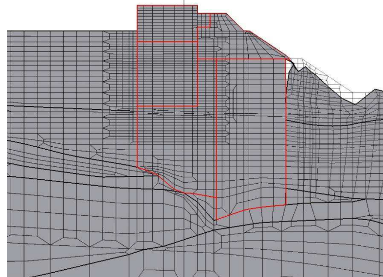
■変形図(曲げ圧縮及びせん断最小安全率時, 倍率1倍)
