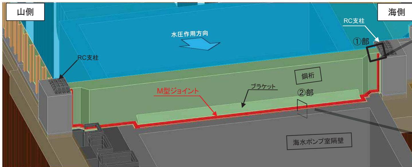
M型ジョイント 設置概要 (鋼製遮水壁(鋼桁)-海水ポンプ室(隔壁))
