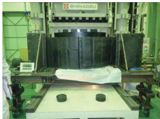
変形+耐圧試験状況 (変形状態を保持し、0.15MPa相当を載荷)
