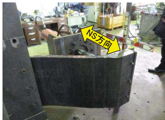
変形試験状況 (NS方向)
