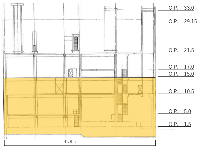
第6-2図 1号炉制御建屋（南面）の地盤の接地状況
