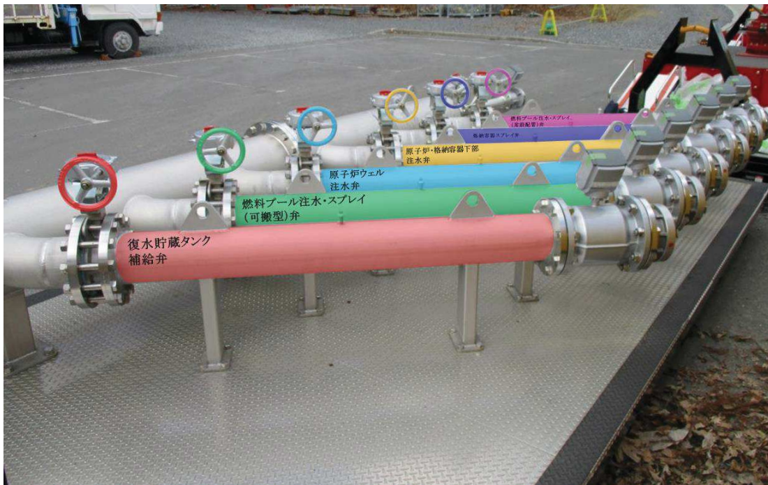
図 51-11-3 注水用ヘッドの誤接続及び誤操作の防止対策イメージ図
