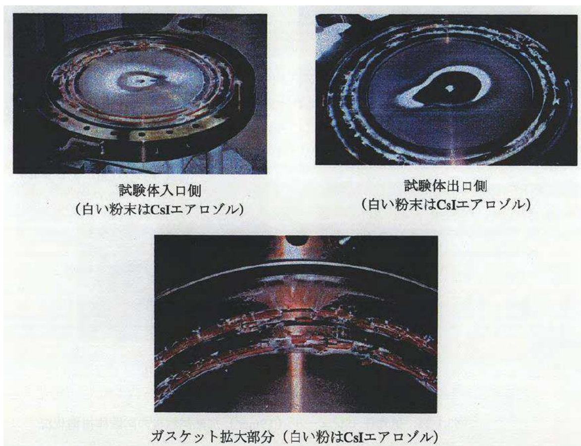
図 2-24-9 試験で用いたフランジ・ガスケットの損傷状態 (200°Cを超過して約0.5°C/minの昇温速度で過熱，漏えい発生後， 温度を低下させ，エアロゾル捕集特性試験を実施した後の状態)
