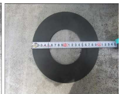
供試体(止水目地①-2相当) φ200mm×φ100mm(穴抜き) 厚さ5mm
