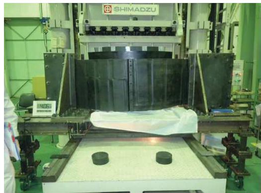
変形+耐圧試験状況① (変形状態を保持し, 0.15Mpa相当を載荷)
