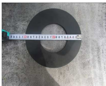
供試体(止水目地①-1相当) φ200mm×φ100mm(穴抜き) 厚さ10mm
