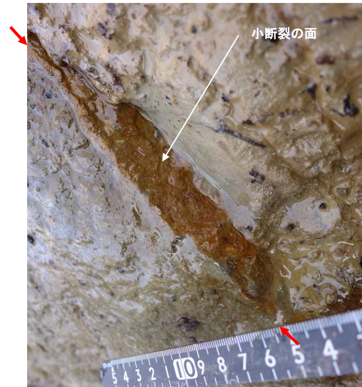
小断裂の面は、平滑ではなく起伏がある 小断裂の面には、条線、鏡肌、粘土等は認められない
