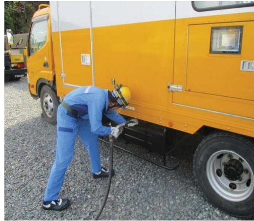
電源車への補給
