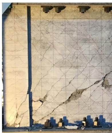
試験体S-06-D0 最終破壊時写真・ひび割れ図
