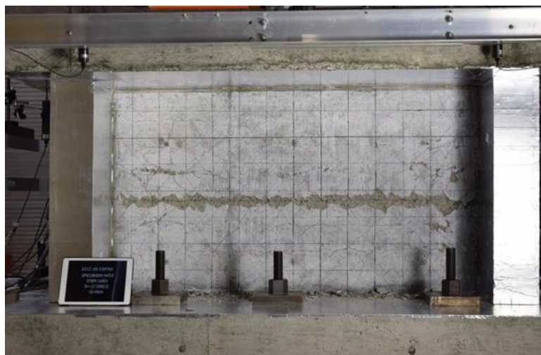
(+) 乾燥試験体[1] 最終破壊時写真 (-)
