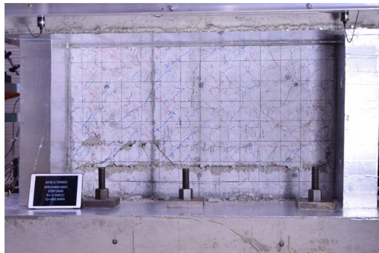
乾燥試験体[2] 最終破壊時写真
