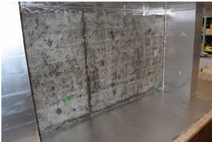
乾燥試験体[2]養生状況
