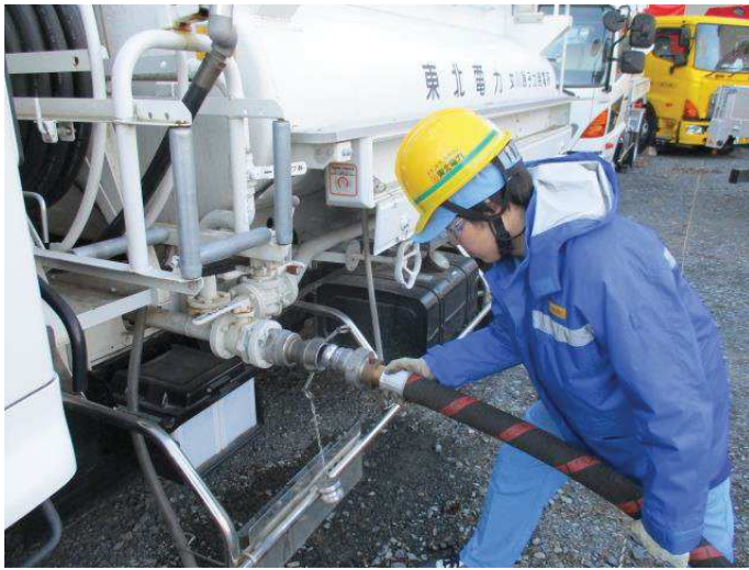
タンクローリへのホース接続
