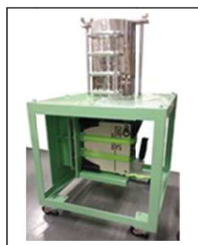
(可搬型 Ge 半導体試料放射能 測定装置のイメージ)
