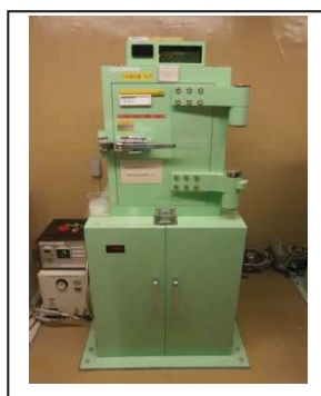
(Ge 半導体試料放射能測定装置 のイメージ)
