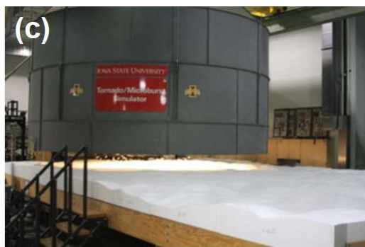
第 3-1 図 風洞実験の様子 (Karstens 2012)
