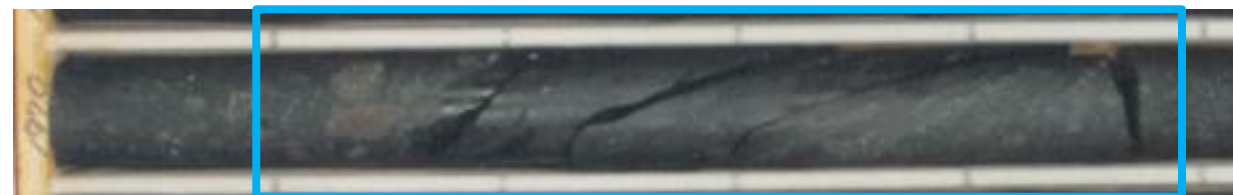
ボーリングコア 試料採取箇所
