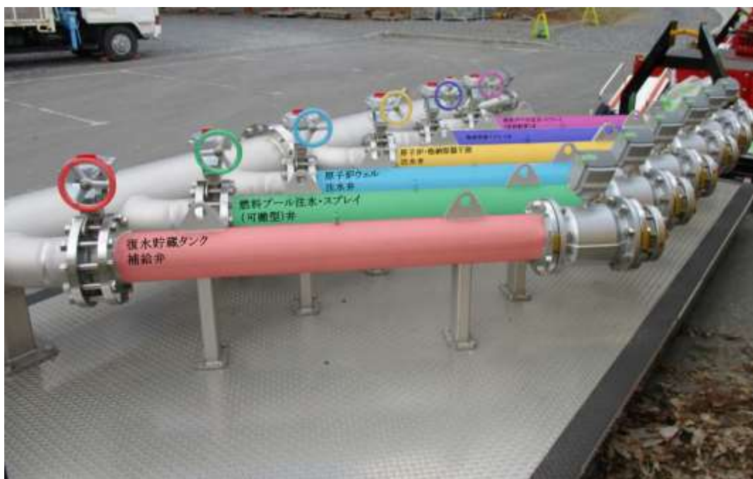
図 50-12-3 注水用ヘッドの誤接続及び誤操作の防止対策イメージ図
