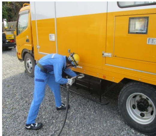
電源車への補給
