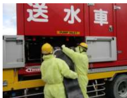
大容量送水ポンプ (タイプ I) へのホース接続
