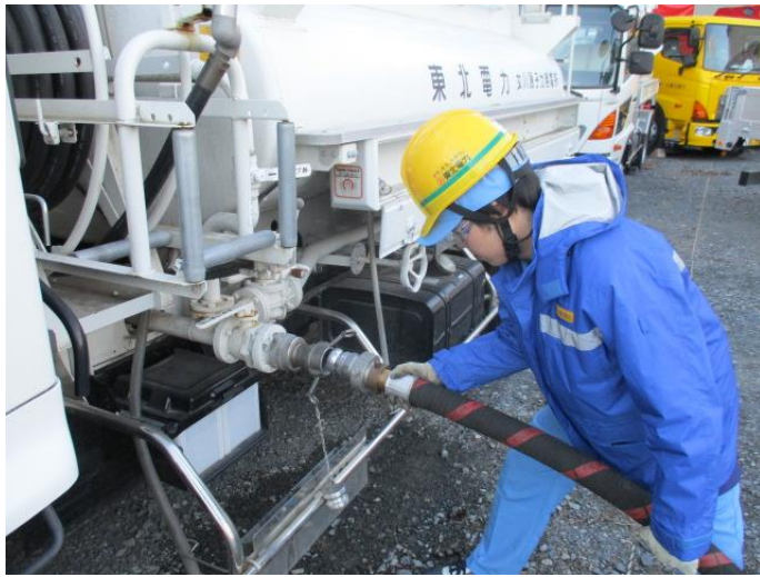
タンクローリへのホース接続
