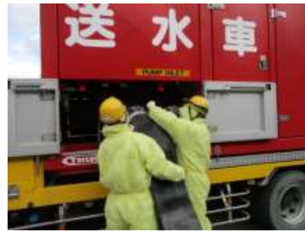
大容量送水ポンプ（タイプ I）へのホース接続
