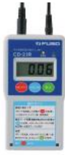
図 61-5-9 二酸化炭素濃度計の概略図
