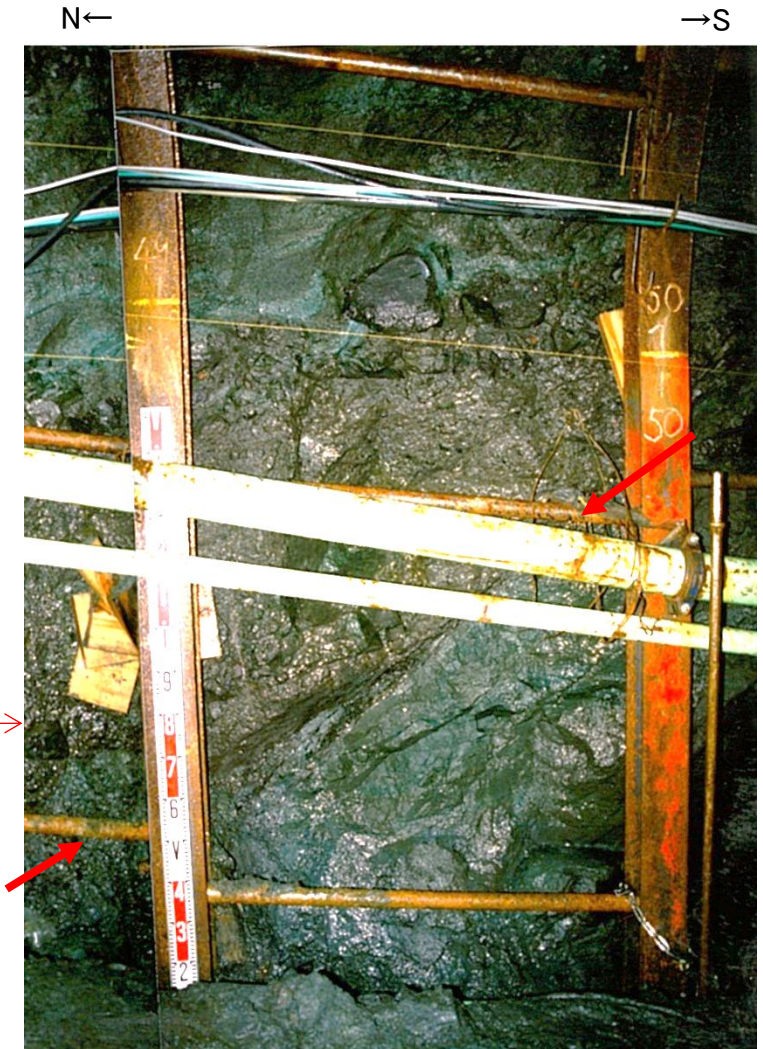
試掘坑東壁面で確認されたf-1断層
