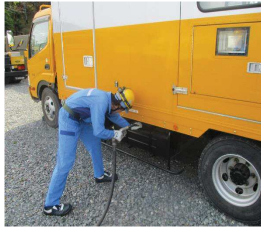
電源車への補給
