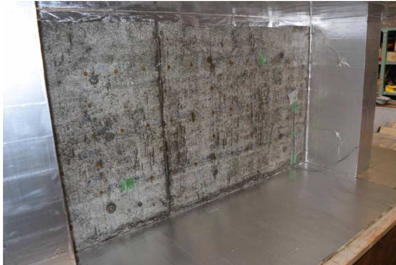
図1 乾燥試験体養生状況 (ウェブ部:コンクリート打設後約一週間で脱型し, 期中養生, フランジ部:アルミテープにより密封養生)
