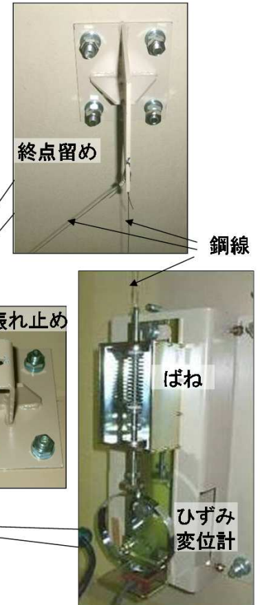
第2.2-4-9図 変位計測システムの設置詳細
