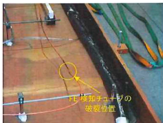
第5図：試験 H1 における発火・消火時の状態
