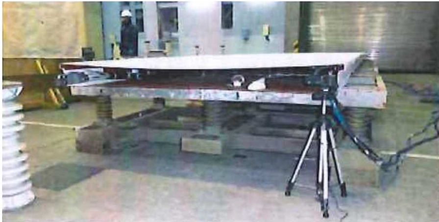
第3図：消火実証試験用のケーブルトレイ外観
