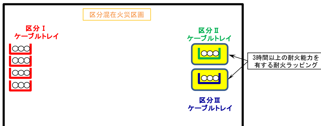
第3図：ケーブルトレイ3時間ラッピングの概要
