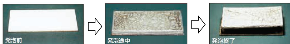
第3図：発泡性耐火被覆の発泡状況
