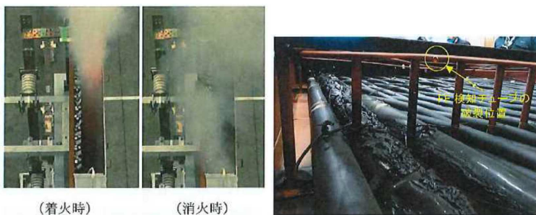
第 11 図：試験 V2 における発火・消火時の状態
