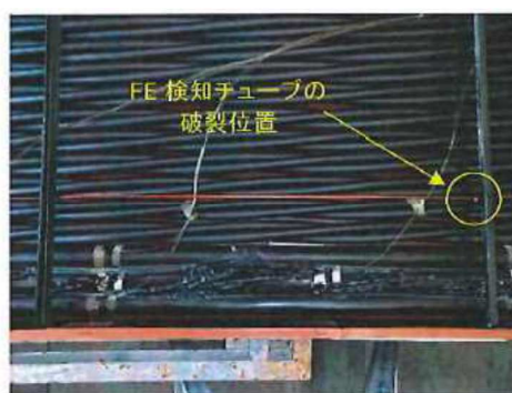
第 7 図：試験 H2 における発火・消火時の状態
