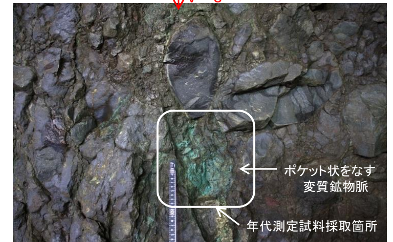
③変質鉍物脈は部分的にポケット状(軟質な緑色粘土鉍物を挟む)に厚くなるが、上下に節理状の細脈となる。
