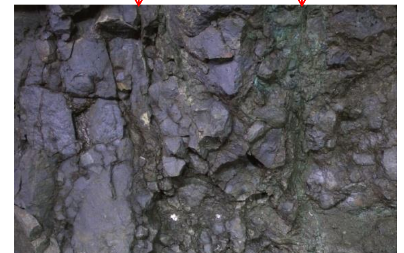
④2条の変質鉍物脈は、写真より下方で会合し、1条となる。
