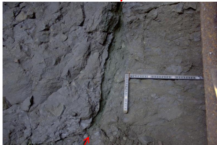
①変質鉍物脈と母岩の境界は直線的ではなく起伏が激しい。上方では脈幅が狭くなり、節理状となる。
