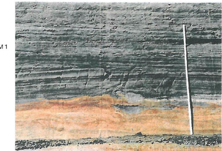
蒲野沢層を被覆するM 1 面段丘堆積物中の変位のない高角度断裂群) 【Tr21 トレンチ北法面 中央～東側】
