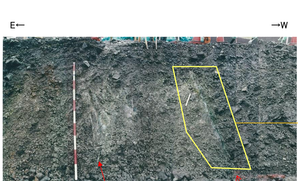
泊層上部層 安山岩溶岩 やや割れ目が多い 小破碎部 m-a断層 泊層上部層 凝灰角礫岩
