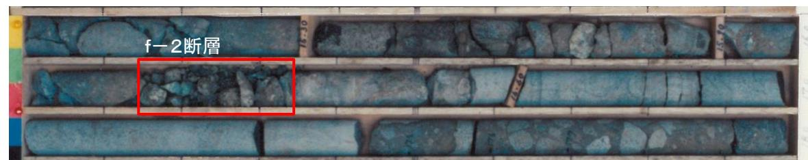
O-4孔深度16.12m~16.35m:細片, 岩片状をなすが、破碎性状は不明瞭。f-2断層と認定。
