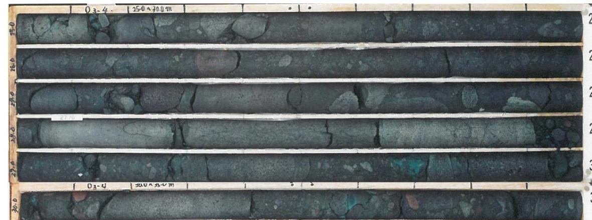
O<sub>3</sub>-4孔:f-2断層の延長部に相当する深度28m付近には、破碎部は認められない。
