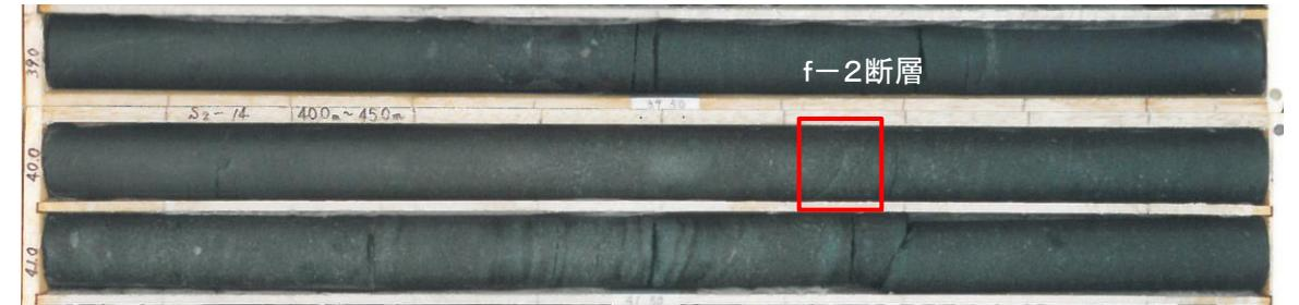
S<sub>2</sub>-14孔 深度40.64m~40.65m: 幅1mm~3mm灰色粘土挟在, 鏡肌, 条線あり, 傾斜約40°。
