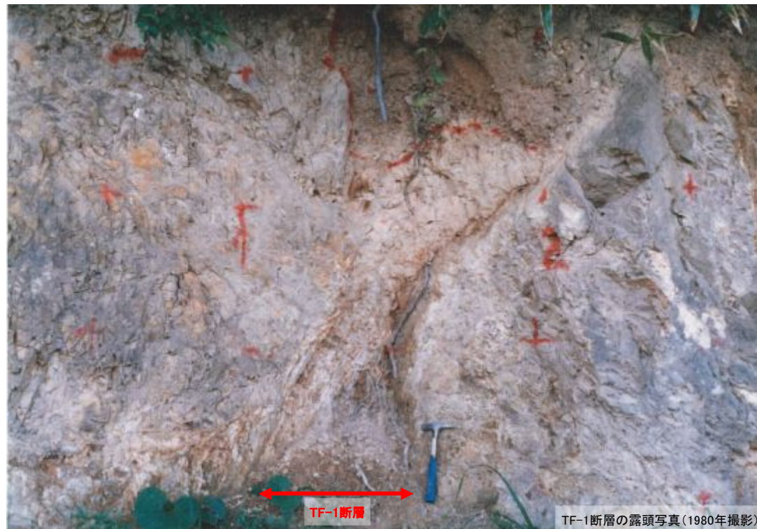
3号炉試掘坑2坑北西壁で確認したTF-1断層 (左:スケッチ, 右:写真)
